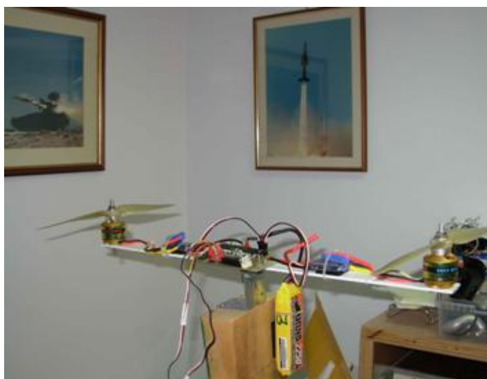
Σχήμα 3-4. Έλεγχοι της σταθεράς C_T της στατικής ώσης στροφείων.
