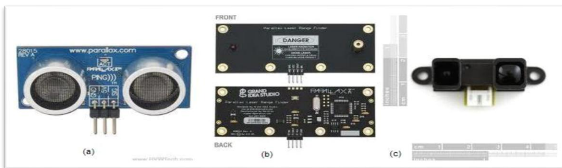
Σχήμα 5-11. Αισθητήρες ανίχνευσης απόστασης (a) Υπέρηχων (b) Λέιζερ (c) Υπέρυθρων
