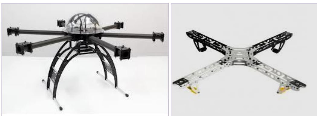
Σχήμα 5-1. Πλαίσιο για ιπτάμενο όχημα πολλών στροφείων από ίνες άνθρακα (αριστερά) ανοδιωμένο αλουμίνιο (δεξιά)
