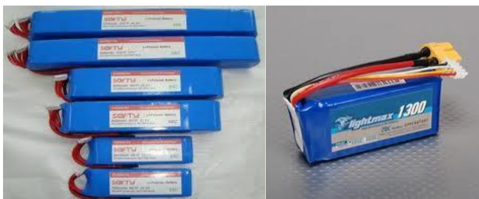
Σχήμα 5-4. Μπαταρίες LiPo διαφόρων διαστάσεων και χωρητικότητας
