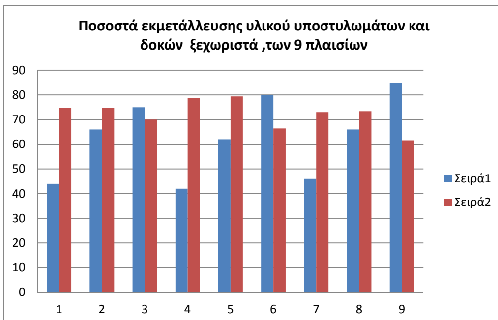
Σχήμα 8.2 Ποσοστά εκμετάλλευσης υλικού υποστυλωμάτων και δοκών (ξεχωριστά) Κόκκινο-υποστυλώματα, Μπλε-δοκάρια
