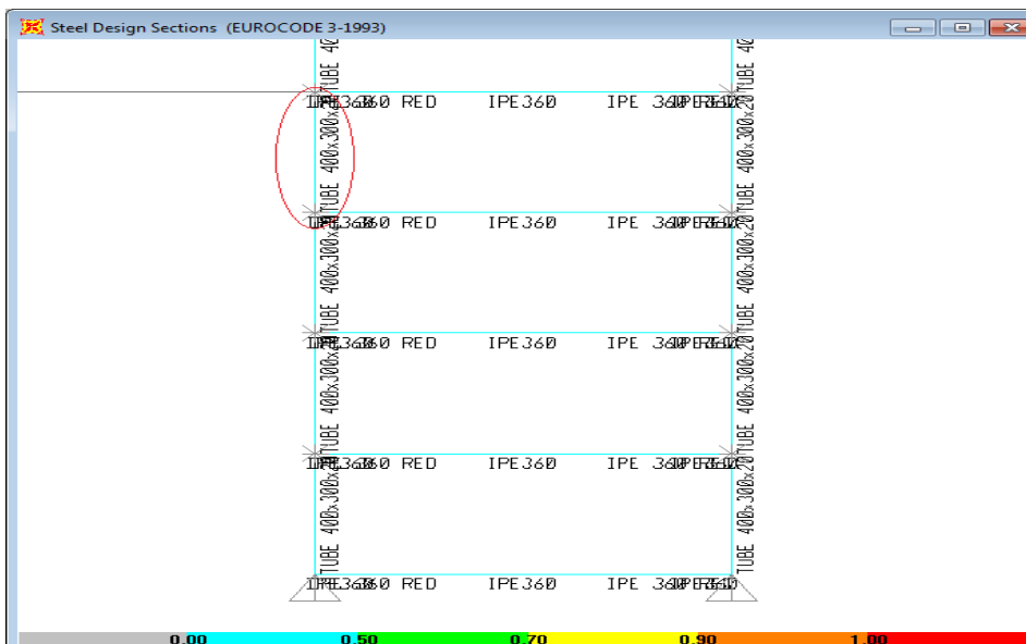
Σχήμα 4.37 Λεπτομέρεια της ίδιας όψης με επισήμανση της δυσμενέστερης διατομής υποστυλώματος fuseis(18,7% με γαλάζιο χρώμα)
