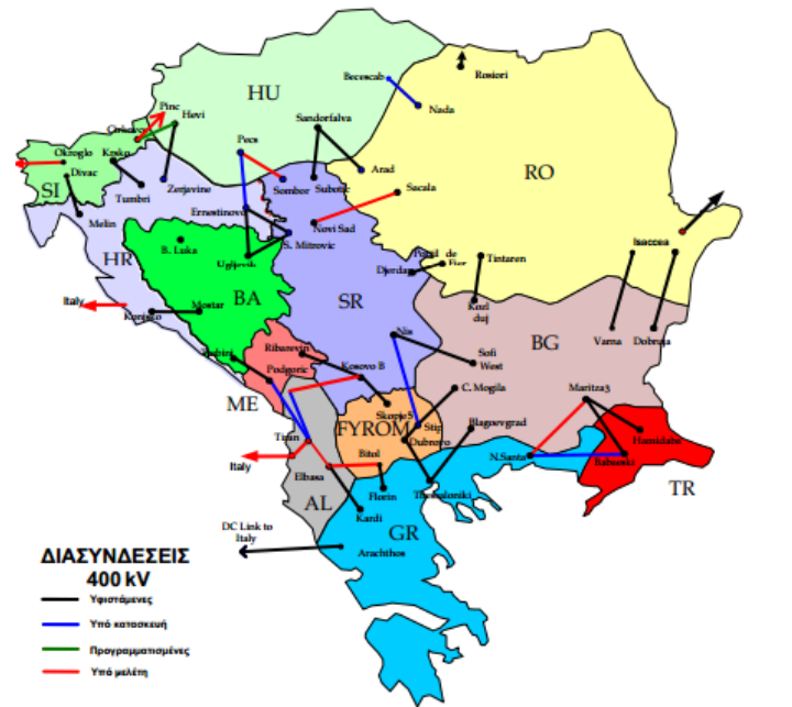
Εικόνα 2.8: Σχηματικό διάγραμμα των Διασυνδεδεμένων Συστημάτων της Βαλκανικής [21]
