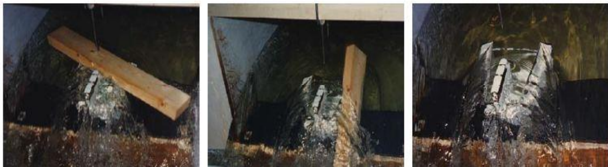
Εικόνες 2.14, 2.15, 2.16 Πειραματικές δοκιμές του Εργαστηρίου TVA (ΗΠΑ) για τη μελέτη της επίδρασης επιπλεόντων φερτών σε λαβυρινθοειδή ανατρεπόμενα θυροφράγματα
