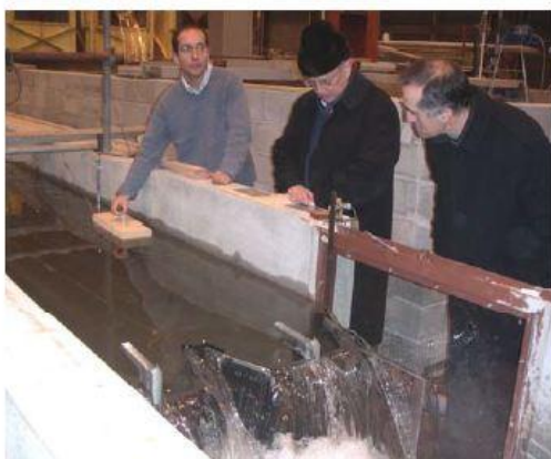
Εικόνα 2.13 Πειραματικό μοντέλο για τη μελέτη της επίδρασης επιπλεόντων φερτών σε fusegates
