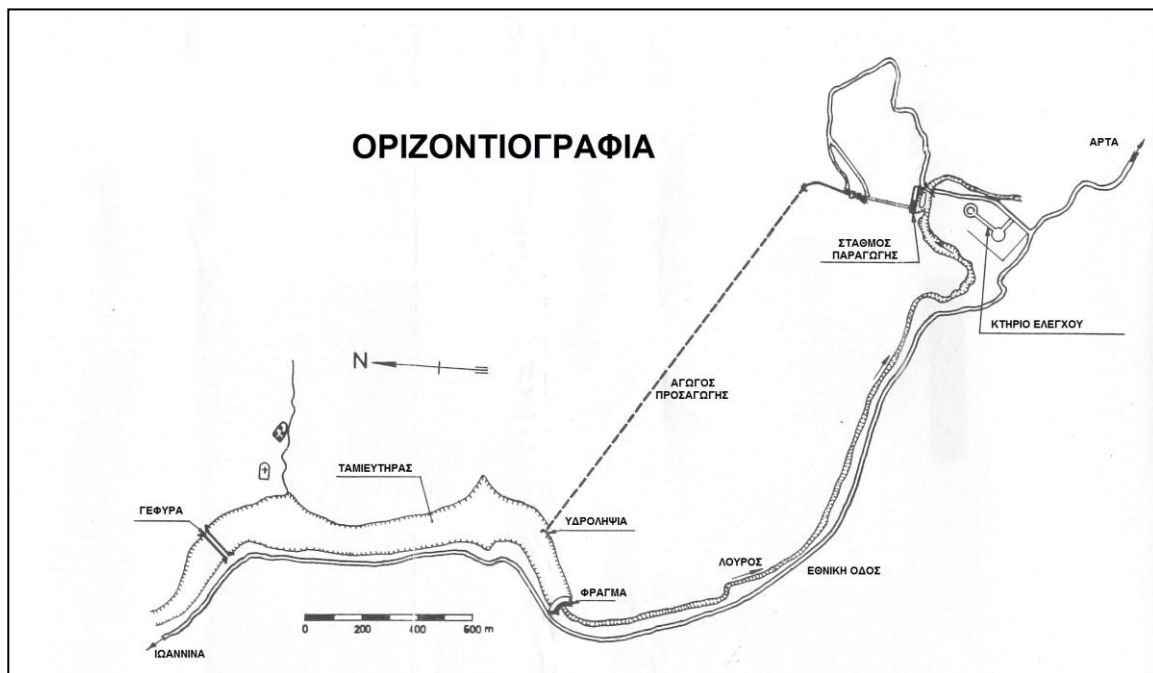
Σχήμα 4.7 Οριζοντιογραφία του έργου. Διακρίνεται στο νοτιοανατολικό άκρο του έργου η θέση του σταθμού παραγωγής (power house).
