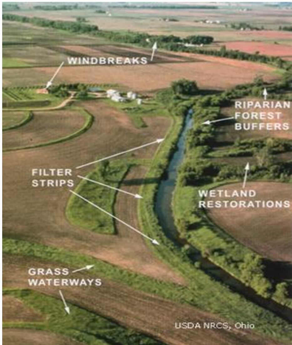
Εικόνα 19 Αντιμετώπιση ρυπαντικών φορτίων απορροών με τη χρήση υδροβιότοπων, παρόχθιας βλάστησης & άλλων μέσων φυτοκάλυψης
