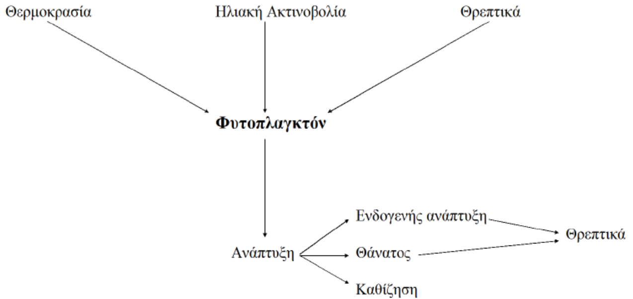
Σχήμα 6 Μοντέλο Ευτροφισμού Διαλυμένου Οξυγόνου Μεταβολή Φυτοπλαγκτόν
