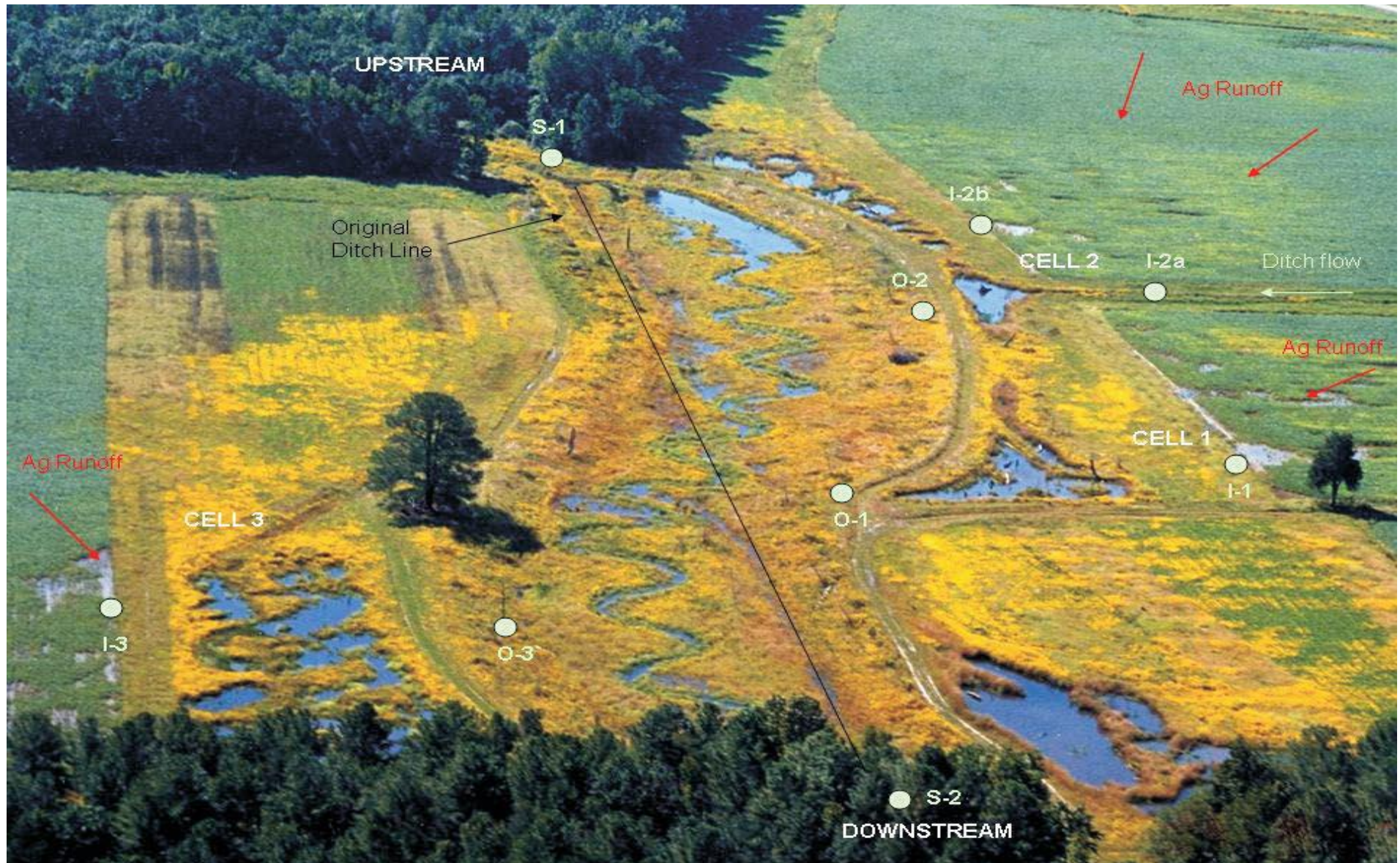
Εικόνα 18 Αντιμετώπιση ρυπαντικών φορτίων αγροτοκτηνοτροφικών απορροών με τη χρήση υδροβιότοπων
