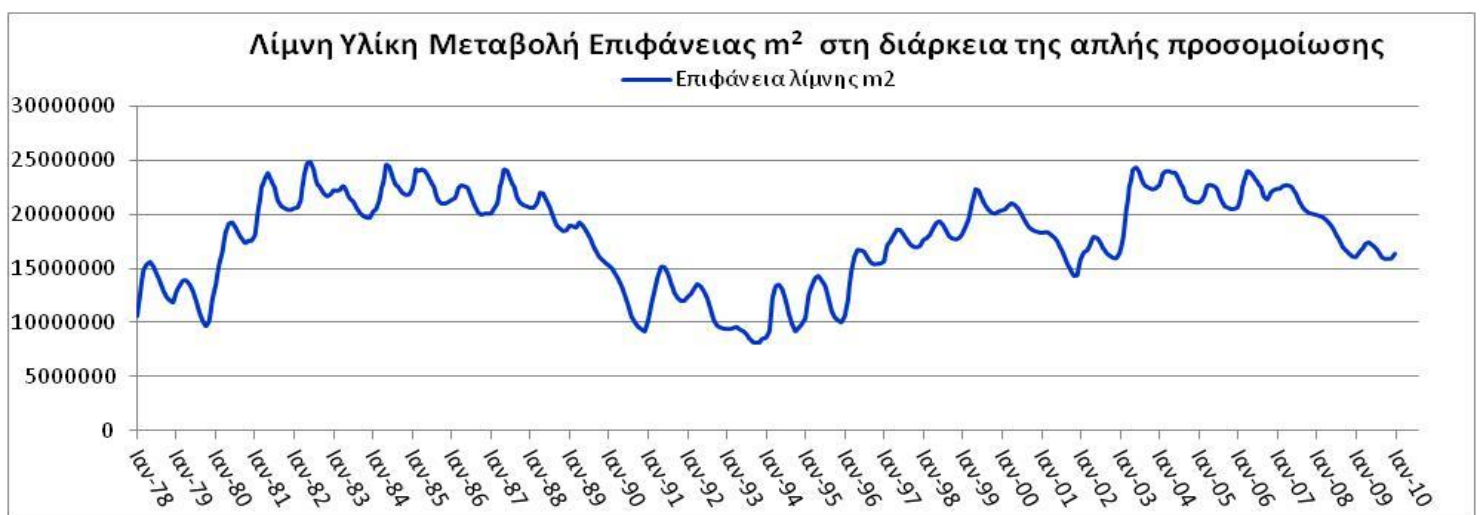
Σχήμα 53 Λίμνη Γλίκη Διακύμανση επιφάνειας m^2 από 1-1-78 έως και 31-12-09
