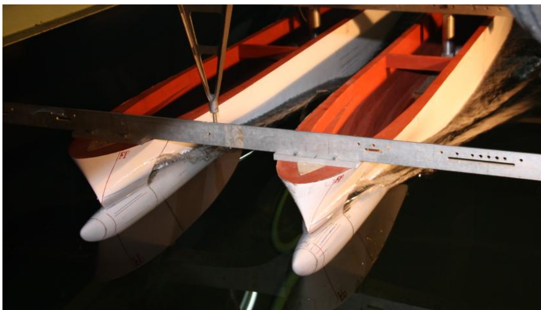
Εικόνα 6: Πειραματικό μοντέλο σε δοκιμή αντίστασης, κατάσταση B3, S/L=0.185 , F_n=0.41
