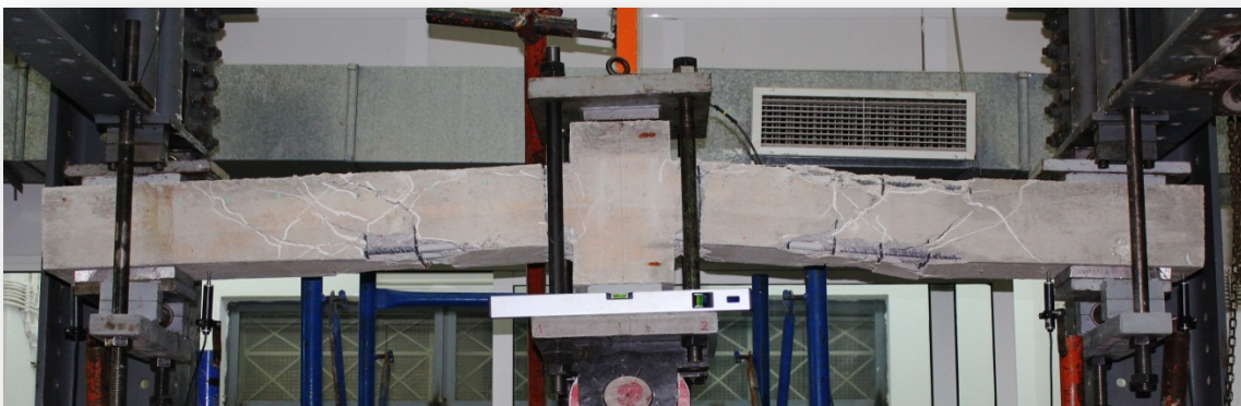
ΕΙΚΟΝΑ 4.6 Ρηγματωμένη κατάσταση του φορέα μετά την διαρροή.
