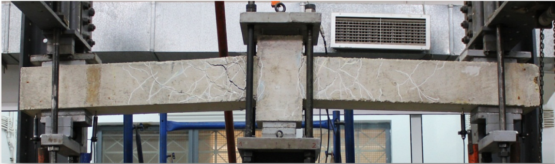
ΕΙΚΟΝΑ 4.1 Ανακυκλιζόμενη φόρτιση .
