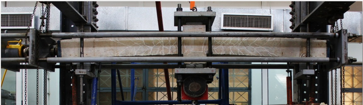
ΕΙΚΟΝΑ 4.9 Ρηγμάτωση του φορέα στην θέση επιβολής του εγκάρσιου φορτίου.
