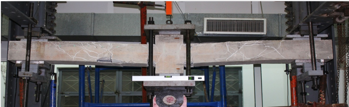
ΕΙΚΟΝΑ 4.5 Ανακυκλιζόμενη φόρτιση.
