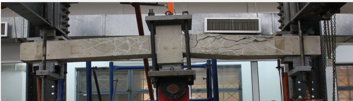
ΕΙΚΟΝΑ 4.4 Αστοχία δοκιμίου υπό Ανακυκλιζόμενη φόρτιση.
