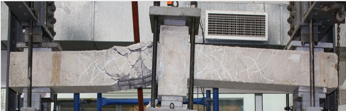
ΕΙΚΟΝΑ 4.1 Ανακυκλιζόμενη φόρτιση .
