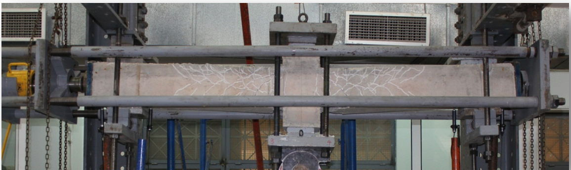
ΕΙΚΟΝΑ 4.7 Ρηγματωμένη κατάσταση του φορέα .
