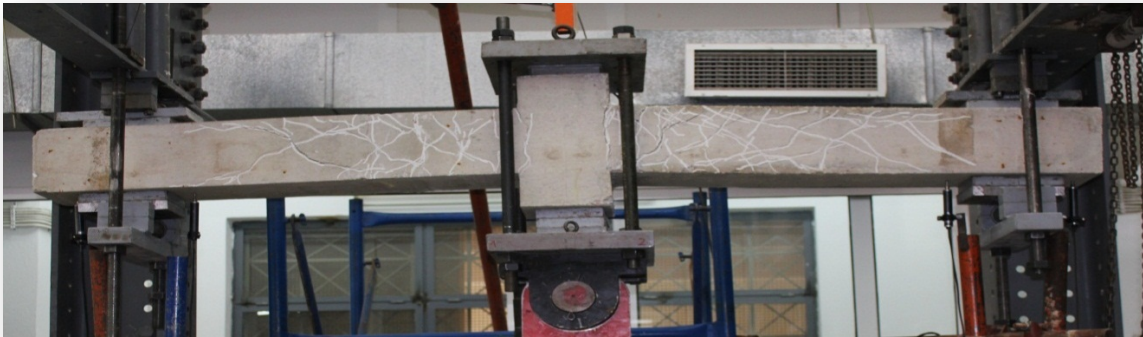
ΕΙΚΟΝΑ 4.3 Ανακυκλιζόμενη φόρτιση .
