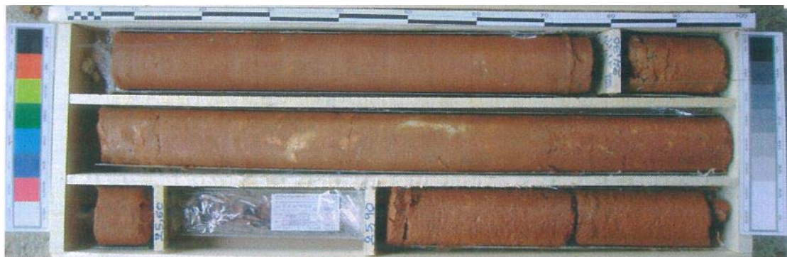
Εικόνα 4.3-4 Δείγματα γεωτρήσεων ενότητας A2c (ΓΕΩΓΝΩΣΗ Α.Ε., 2007)
