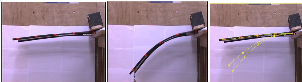
Εικόνα 12β: Φωτογραφίες προφίλ πτερυγίου σε άφορτη και υπο φορτίο κατάσταση, για τον υπολογισμό της ακαμψίας EIdownstroke
