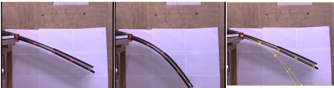
Εικόνα 12α: Φωτογραφίες προφίλ πτερυγίου σε άφορτη και υπο φορτίο κατάσταση, για τον υπολογισμό της ακαμψίας Eiupstroke
