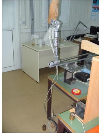
Εικόνα 7: Ανάρτηση βαρών ως προς άξονα γ-γ παράλληλο κατά μήκος του βραχίονα
