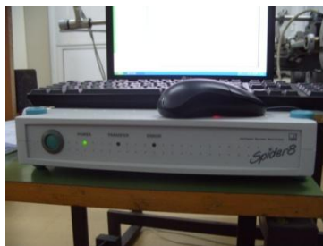
Εικόνα 2γ: συσκευή μετατροπής του αναλογικού σήματος σε ψηφιακές τιμές (HBM spider8)
