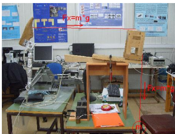
Εικόνα 8: Ανάρτηση βαρών με την βοήθεια τροχαλίας ώστε ο άξονας δράσης τους να είναι κάθετος στον βραχίονα κίνησης
