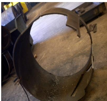
Εικόνα 6-2: Στεφάνι σωλήνα μετά την κοπή δοκιμίων
