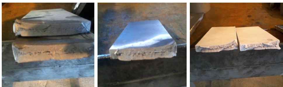
Εικόνα 7-8 : Θραυσιγενής επιφάνειες των δειγμάτων μετά την δοκιμή DWTT
