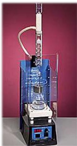
Εικόνα 5.15 Συσκευή Digesdahl Digestion
