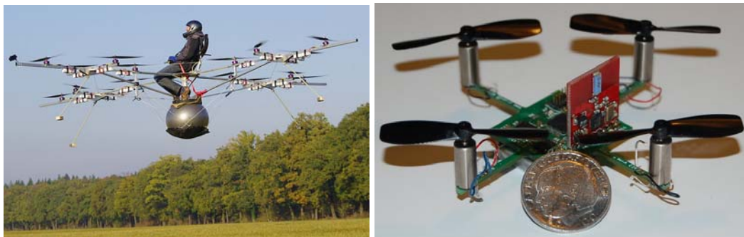
Σχήμα 1-2. Το πρώτο επανδρωμένο MRAV, με 16 έλικες (αριστερά), ένα από τα πιο μικρά quadrotor (δεξιά) [51] .
