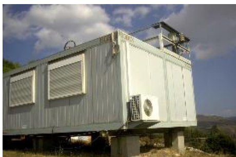
Εικόνα 17: Μετεωρολογικός σταθμός Πεντέλης του Ινστιτούτου Ερευνών Περιβάλλοντος και Βιώσιμης Ανάπτυξης και όργανο μέτρησης της διάχυτης ηλιακής ακτινοβολίας στο οριζόντιο επίπεδο, με χρήση στεφάνης σκίασης Πηγή: Ινστιτούτο Ερευνών Περιβάλλοντος και Βιώσιμης Ανάπτυξης
