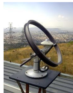
Εικόνα 17: Μετεωρολογικός σταθμός Πεντέλης του Ινστιτούτου Ερευνών Περιβάλλοντος και Βιώσιμης Ανάπτυξης και όργανο μέτρησης της διάχυτης ηλιακής ακτινοβολίας στο οριζόντιο επίπεδο, με χρήση στεφάνης σκίασης Πηγή: Ινστιτούτο Ερευνών Περιβάλλοντος και Βιώσιμης Ανάπτυξης
