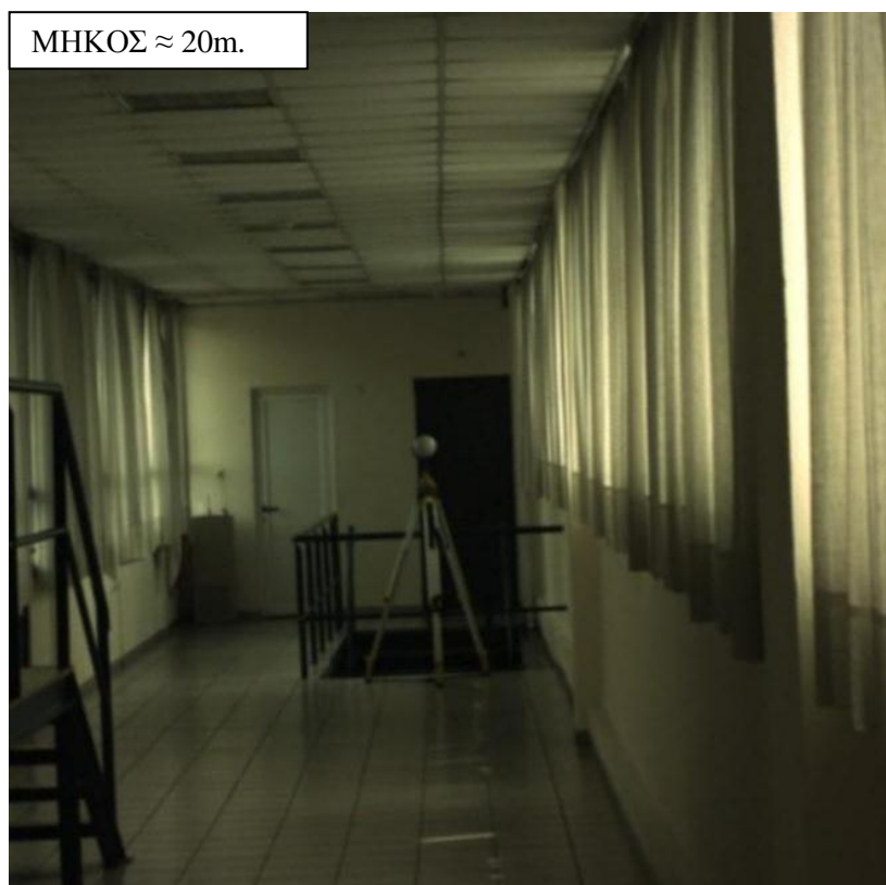
Εικόνα 5.6: Τοποθέτηση σφαιρικού στόχου στην απόσταση των 20 m.
