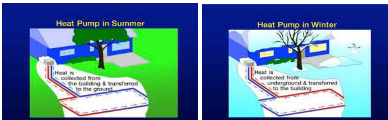
Εικόνα 7: Χρήση γεωθερμίας για θέρμανση και κλιματισμό
