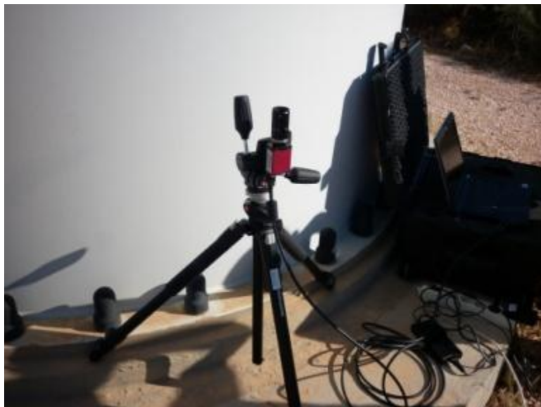
Σχήμα 2.10: Σύστημα Βιντεομετρίας της εταιρίας Imetrum, Video Gauge (Μπακογιάννης, 2010)
