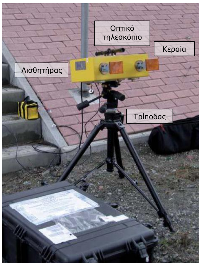
Σχήμα 4.8: Το σύστημα IBIS-S (Rödelsperger et al., 2010)
