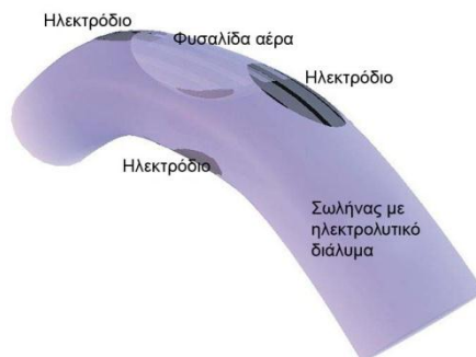
Σχήμα 3.4: Αρχή λειτουργίας του ηλεκτρονικού κλισιμέτρου (en.wikipedia)
