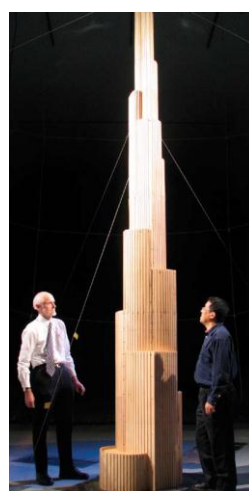
γ. Ομοίωμα για μοντέλο εκτίμησης δύναμης κλίμακας 1:50 (Irwin et al., 2006)
