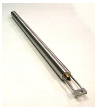
β. Κλισίμετρο της εταιρείας Applied Geomechanics σχεδιασμένο ειδικά για ηφαιστειακές, τεκτονικές και υδραυλικές εφαρμογές ( www.esands.com )
