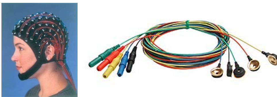
Σχήμα 1. 5 Τοποθέτηση ηλεκτροδίων και τυπικά ηλεκτρόδια καταγραφής σε μορφή δίσκων
