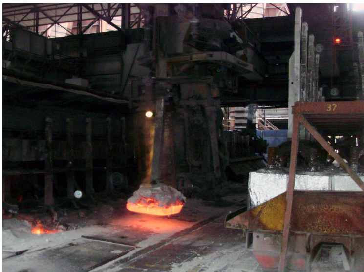
Εικόνα 1.3: Στιγμιότυπο αλλαγής ανόδου, κατά τη διάρκεια ηλεκτρόλυσης στο εργοστάσιο “ΑΛΟΥΜΙΝΙΟΝ Α.Ε.”.
