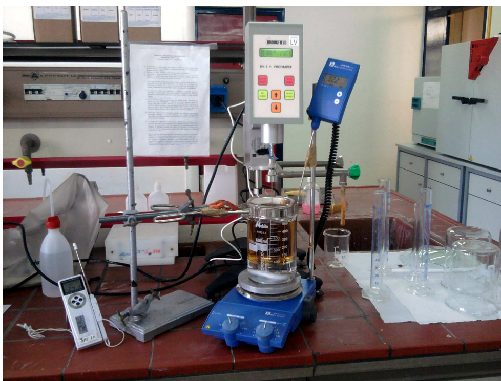
Εικόνα 2.3: Συσκευή και πειραματική διάταξη μέτρησης του ιξώδους.
