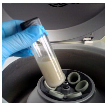
Εικόνα 2.7: (α) Φυγοκέντρηση του συστήματος ιοντικό ρευστό / στερεό , (β) διήθηση υπό κενό για τον διαχωρισμό των δύο φάσεων και (γ) Στερεό υπόλειμμα (1) και διάλυμα (2), μετά την διήθηση.
