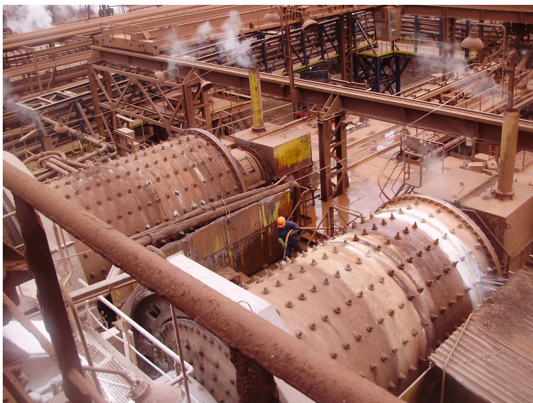
Εικόνα 1.1: Τμήμα Θραύσεως / Λειοτρίβησης στο εργοστάσιο “ΑΛΟΥΜΙΝΙΟΝ Α.Ε.” στην περιοχή Άσπρα Σπίτια Βοιωτίας.
