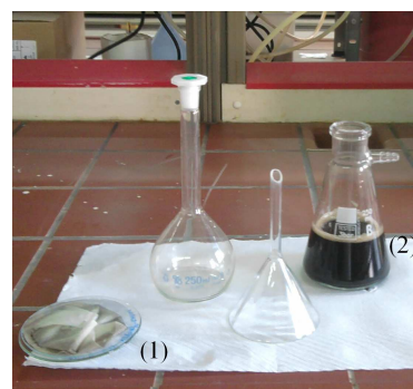
Εικόνα 2.7: (α) Φυγοκέντρηση του συστήματος ιοντικό ρευστό / στερεό , (β) διήθηση υπό κενό για τον διαχωρισμό των δύο φάσεων και (γ) Στερεό υπόλειμμα (1) και διάλυμα (2), μετά την διήθηση.
