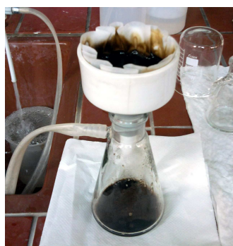
Εικόνα 2.7: (α) Φυγοκέντρηση του συστήματος ιοντικό ρευστό / στερεό , (β) διήθηση υπό κενό για τον διαχωρισμό των δύο φάσεων και (γ) Στερεό υπόλειμμα (1) και διάλυμα (2), μετά την διήθηση.
