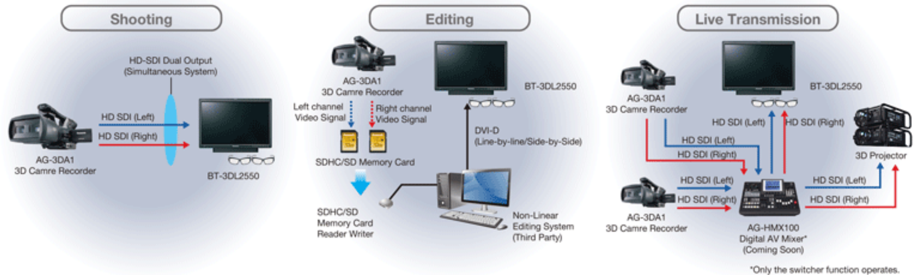
Εικόνα 39, προβολή μετά από λήψη με στερεοσκοπική κάμερα, http://camerent-news.blogspot.gr/2011/01/video-camera-crane-jib-hire-and-rental.html
