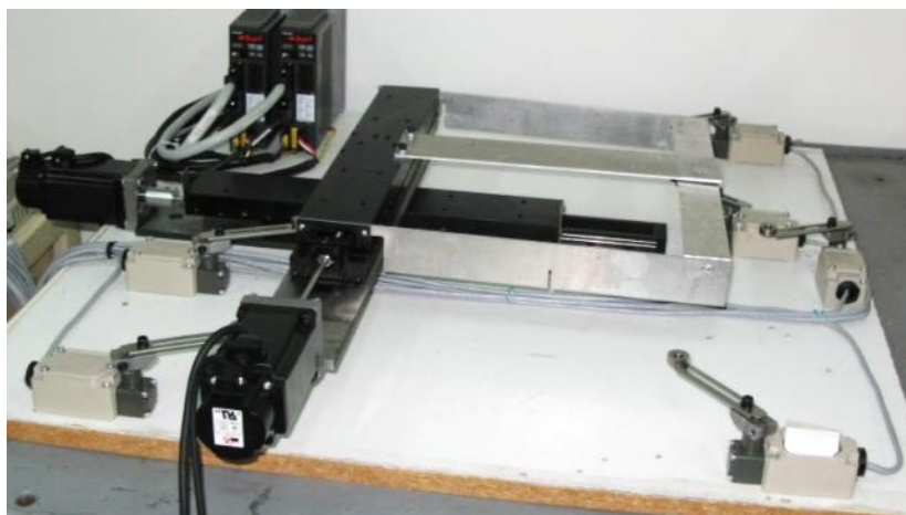
Εικόνα . Παρουσίαση των τελικών θέσεων των τερματικών διακοπών θέσεων «μηδέν» και τερματικών ορίων των αξόνων X,Y.
