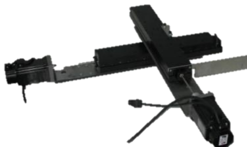
Εικόνα . Υλοποίηση Καρτεσιανού συστήματος X-Y.
