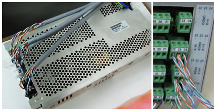
Εικόνα . Διασύνδεση CUIF με τροφοδοτικό LPQ154.
