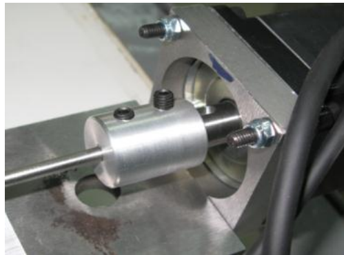
Εικόνα . Αυτοσχέδιο Κόπλερ διασύνδεσης της διάταξης.
