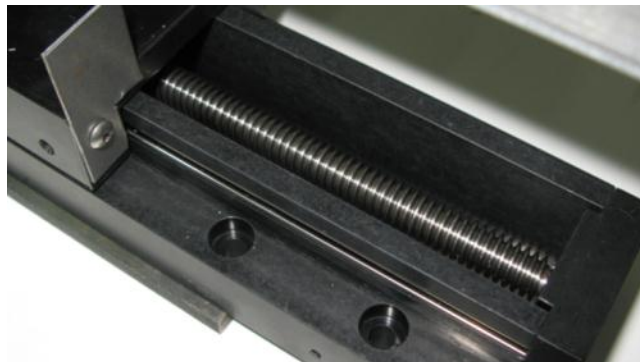
Εικόνα . Κοχλίας διάταξης προώσεως τετραγώνου προφίλ-κανονικού περικοχλίου.
