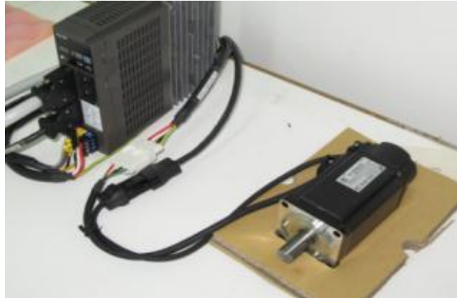
Εικόνα . Σερβοκινητήρας και βαθμίδα ενίσχυσης της σειράς "Faldic-W".
