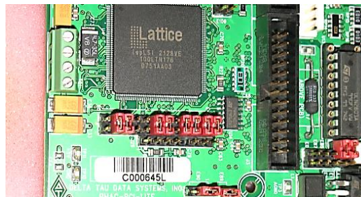
Εικόνα . Σημεία διασύνδεσης στην κάρτα υλικού της Pmac.
