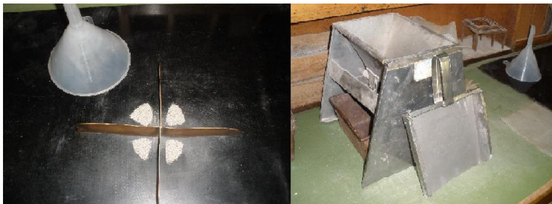
Σχήμα 4.2. Διατάξεις δειγματοληψίας (α) με τη μέθοδο του σταυρού και (β) με τη μέθοδο Jones
