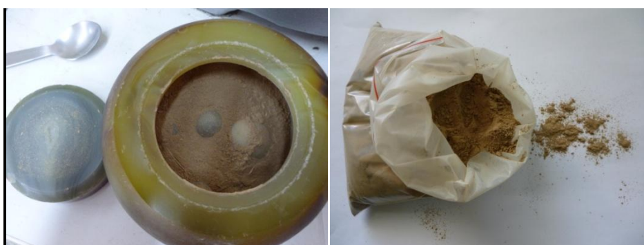
Σχήμα 4.3. Υπερλειοτριβήση του δείγματος για χημικές αναλύσεις στον εργαστηριακό σφαιρόμυλο.
