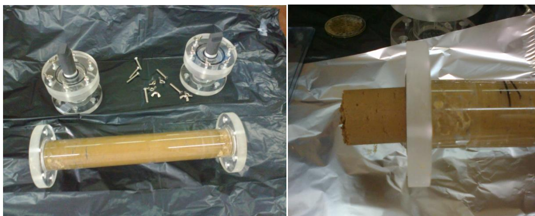
Σχήμα 4.8. Αποσυναρμολόγηση της συσκευής και λήψη δείγματος εδάφους
