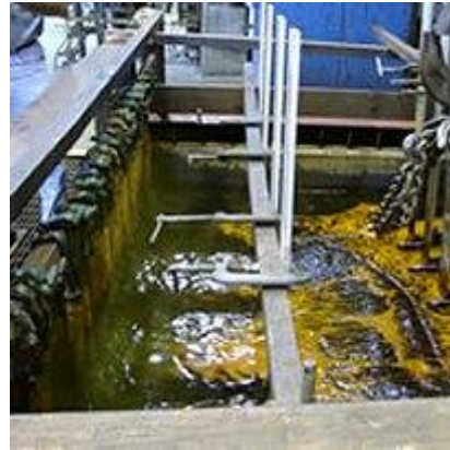
Σχήμα 1.6: Λουτρό επιχρωμίωσης (chrome plating bath)
