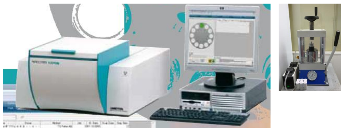
Σχήμα 4.4. Φασματοσκόπιο φθορισμού ακτίνων X SPECTRO XEPOS και συσκευή συμπίεσης ταμπλετών
