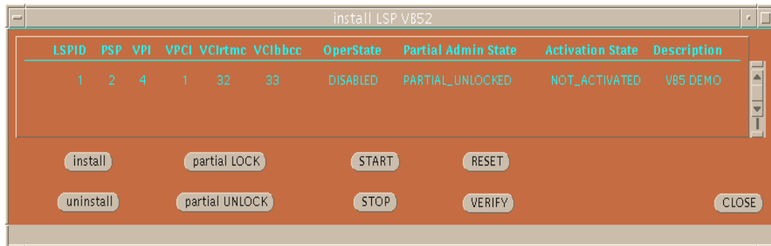
Σχήμα 90 Παράθυρο διαλόγου ανάθεσης τιμών για τη δημιουργία Λογικής Θύρα Υπηρεσίας (LSP) στον Κόμβο Παροχής Υπηρεσιών.
