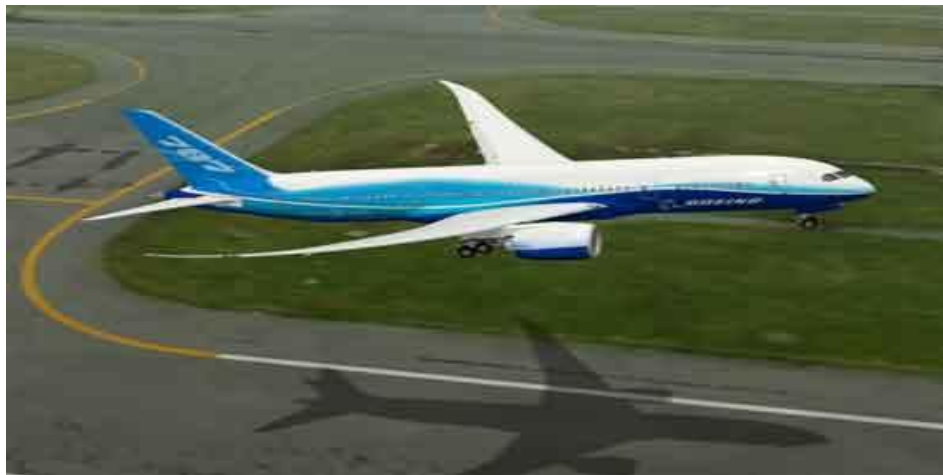
Σχήμα 29. Αεροσκάφος Boeing 787 Dreamliner κατασκευασμένο από 80% σύνθετα υλικά
