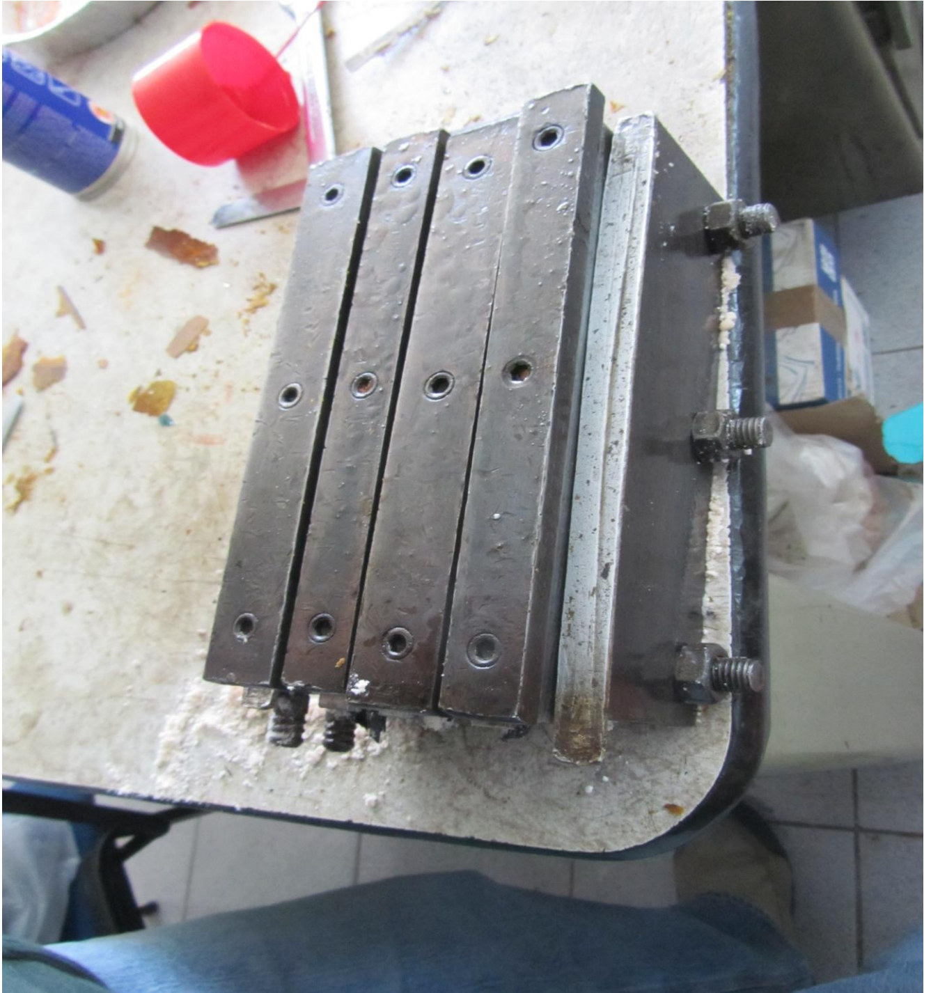
ΚΑΛΟΥΠΙ ΜΕ ΔΟΚΙΜΙΑ ΕΤΟΙΜΟ ΓΙΑ ΘΕΡΜΟΠΡΕΣΣΑΡΙΣΜΑ
