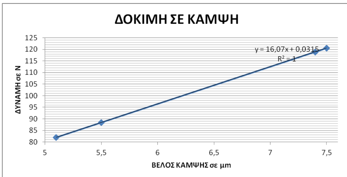
Σχήμα 46. Δοκιμή σε κάμψη ΔΟΚΙΜΙΟ (1)
