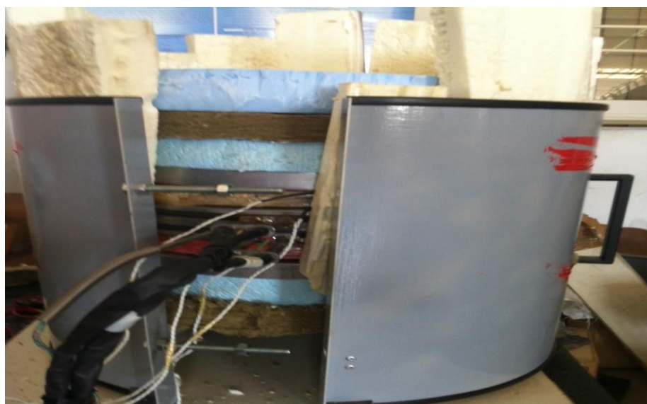
Σχήμα 62. Συσκευή μέτρησης του συντελεστή της θερμικής αγωγιμότητας (εργαστηριακή ιδιοκατασκευή)
