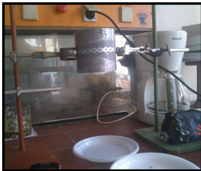
Εικόνα 3.14: πειραματική διάταξη για τη διέλευση οργανικών ρυπαντών.
