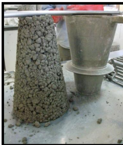
Εικόνα 3.1: Δοκιμή κάθισης πορώδους σκυροδέματος
