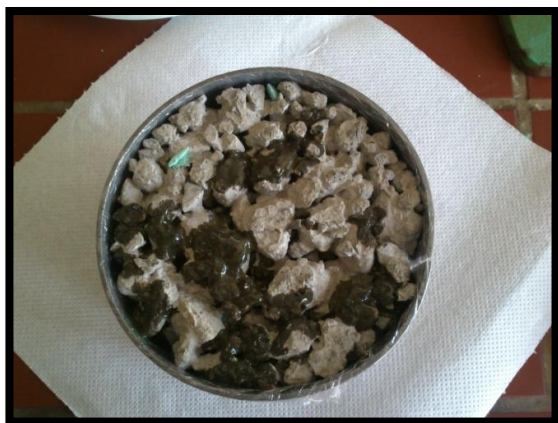
Εικόνα 3.16: Κάτω βάση δοκιμίου μετά τη διέλευση λιπαντικού μηχανής.
