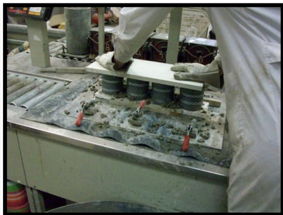
Εικόνα 3.5: Καλούπωμα δοκιμίων (α) γέμισμα μητρών και (β) δόνηση στη δονούμενη τράπεζα.
