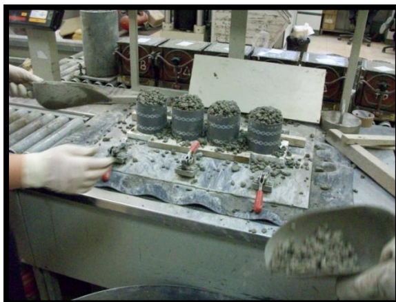
Εικόνα 3.5: Καλούπωμα δοκιμίων (α) γέμισμα μητρών και (β) δόνηση στη δονούμενη τράπεζα.
