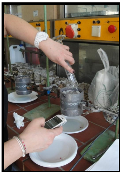
Εικόνα 3.20: Εξέλιξη πειραματικής διαδικασίας απόχυση λιπαντικού και έναρξη χρονομέτρησης.
