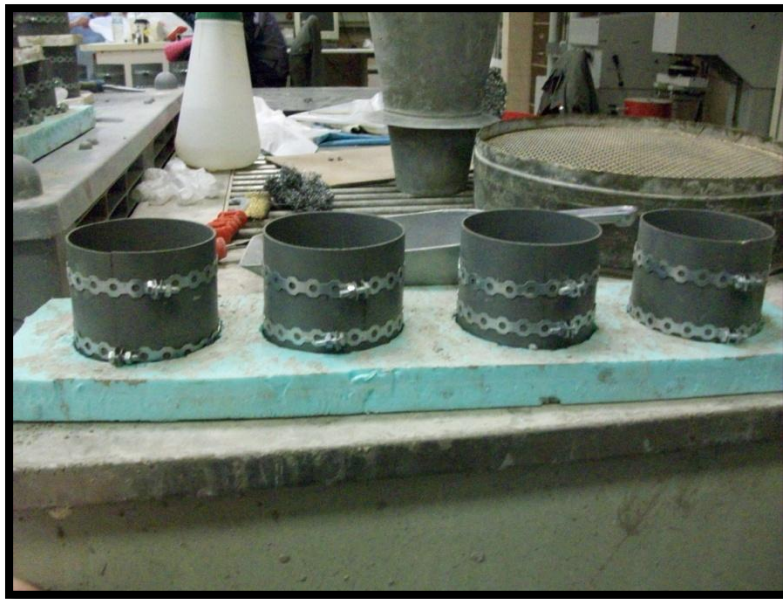
Εικόνα 3.2: Μήτρες PVC για τη σκυροδέτηση κυλινδρικών δοκιμίων διαστάσεων (100mm)χ(100mm)
