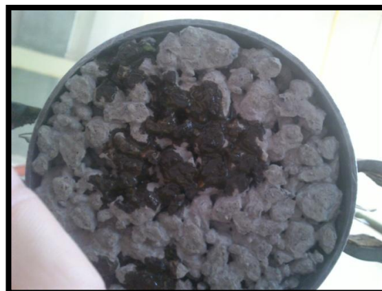
Εικόνα 3.17: Κάτω βάση δοκιμίου μετά τη διέλευση λιπαντικού μηχανής
