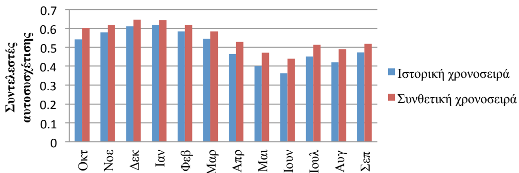
Σχήμα Γ.77 : Ραβδόγραμμα σύγκρισης των ημερήσιων συντελεστών αυτοσυσχέτισης πρώτης τάξης του ιστορικού και συνθετικού δείγματος μέσης ταχύτητας ανέμου για τον σταθμό Hohenpeissenberg.
