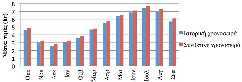
Σχήμα Δ.72 : Ραβδόγραμμα σύγκρισης των ημερήσιων μέσων τιμών του ιστορικού και συνθετικού δείγματος διάρκειας ηλιοφάνειας για τον σταθμό Hohenpeissenberg.
