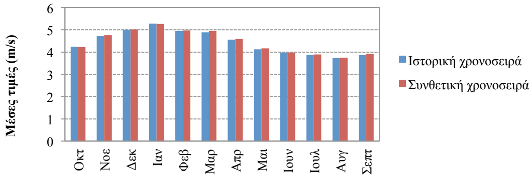
Σχήμα 6.52 : Ραβδόγραμμα σύγκρισης των ημερήσιων μέσων τιμών του ιστορικού και συνθετικού δείγματος μέσης ταχύτητας ανέμου για τον σταθμό Eelde.
