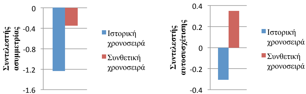
Σχήμα E.20 Ραβδογράμματα σύγκρισης της ετήσιας ασυμμετρίας και του συντελεστή αυτοσυσχέτισης πρώτης τάξης του ιστορικού και συνθετικού δείγματος της ταχύτητας ανέμου.
