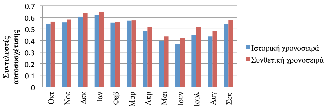
Σχήμα Γ.104 : Ραβδόγραμμα σύγκρισης των ημερήσιων συντελεστών αυτοσυσχέτισης πρώτης τάξης του ιστορικού και συνθετικού δείγματος μέσης ταχύτητας ανέμου για τον σταθμό Karlsruhe.
