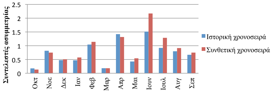
Σχήμα Γ.120 : Ραβδόγραμμα σύγκρισης των μηνιαίων συντελεστών ασυμμετρίας του ιστορικού και συνθετικού δείγματος μέσης ταχύτητας ανέμου για τον σταθμό Maastricht.
