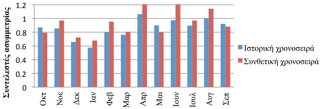
Σχήμα Γ.129 : Ραβδόγραμμα σύγκρισης των ημερήσιων συντελεστών ασυμμετρίας του ιστορικού και συνθετικού δείγματος μέσης ταχύτητας ανέμου για τον σταθμό Maastricht.
