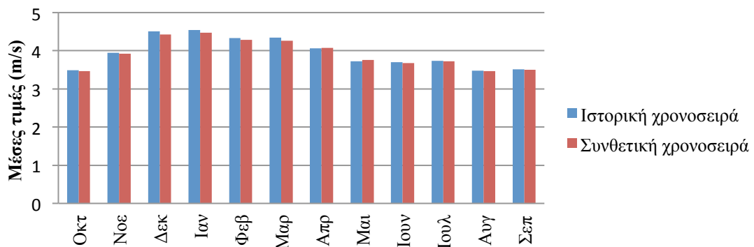
Σχήμα Δ.98 : Ραβδόγραμμα σύγκρισης των ημερήσιων μέσων τιμών του ιστορικού και συνθετικού δείγματος μέσης ταχύτητας ανέμου για τον σταθμό Karlsruhe.
