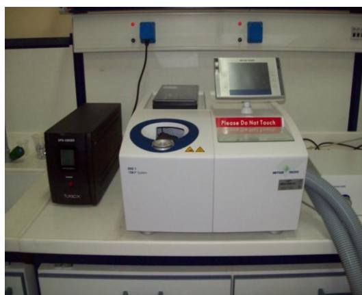
Εικόνα 62: Το σύστημα Mettler DSC 1STARe System που χρησιμοποιήθηκε για τις θερμικές αναλύσεις
