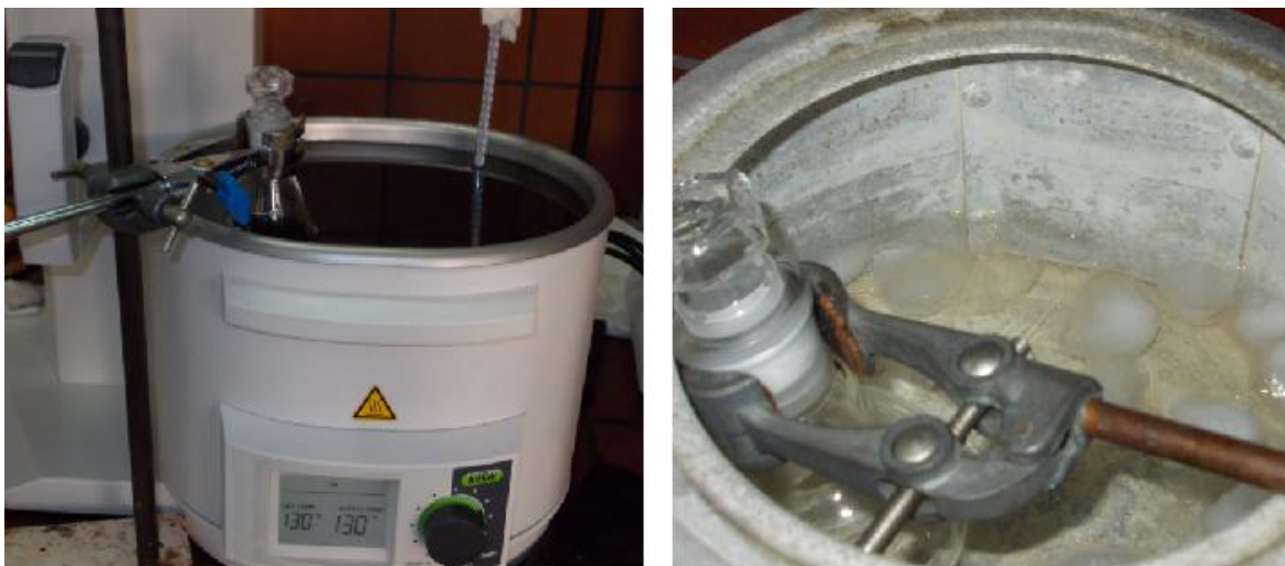
Εικόνα 59: Η απότομη ψύξη του τήγματος του PBS (quenching) προς περιορισμό της ανάπτυξης κρυσταλλικότητας
