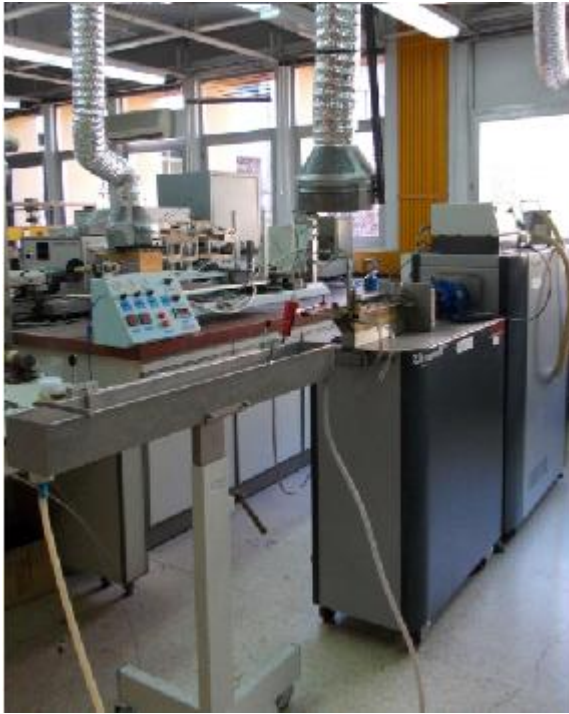
Εικόνα 53: Ο δικόχλιος ομόστροφος εκβολέας Haake (Rheomex PTW16p) της εταιρείας Thermo Fischer Scientific Inc.
