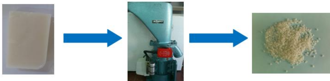
Εικόνα 65: Η κοπή του PBS 12065 με τον κοκκοποιητή της εταιρείας Kayeness σε κόκκους μεγέθους 2,5-2,8 mm
