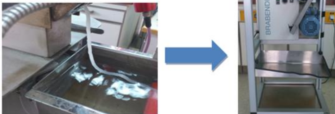
Εικόνα 54: Η εκβολή του PBS και η ψύξη του σε υδατόλουτρο. Ακολουθεί η κοπή του με τον κοκκοποιητή Brabender
