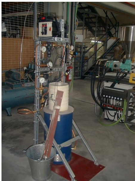
Εικόνα 50: Φωτογραφία διάταξης αντιδραστήρα μεταπολυμερισμού στερεάς κατάστασης στο Ημβιομηχανικό Εργαστήριο της Σχολής Χημικών Μηχανικών (Ε.Μ.Π)
