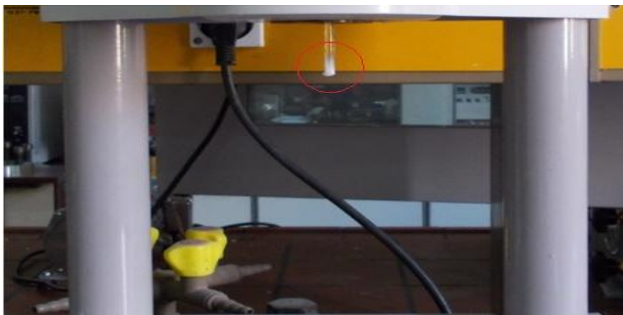
Εικόνα 60: Στιγμιότυπο από τη διεξαγωγή των μετρήσεων του MFI για τα δείγματα της εκβολής. Στο στιγμιότυπο αυτό είναι έκδηλη η μεγάλη κρυσταλλωσιμότητα του PBS
