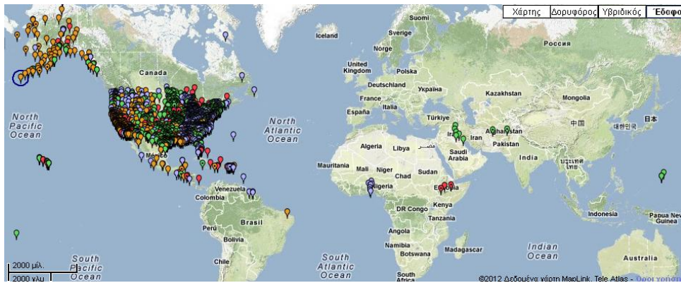
Εικόνα 2.1: Δίκτυο Σταθμών Αναφοράς CORS
