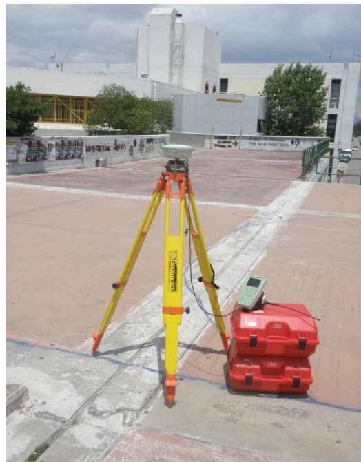
Εικόνα 3.18: Μέθοδος στατικού εντοπισμού στη στάση Σ2
