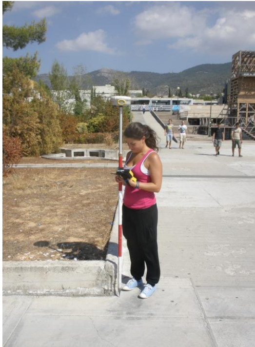
Εικόνα 3.12: Μέθοδος Single Base RTK
