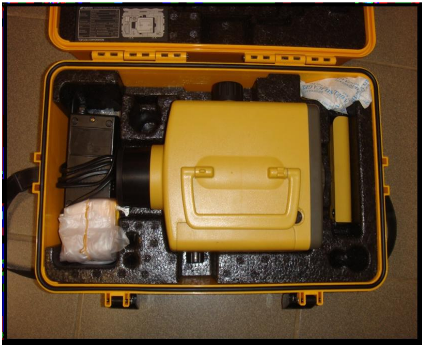
Εικόνα 3.10: Ψηφιακός χωροβάτης TOPCON DL-102C
