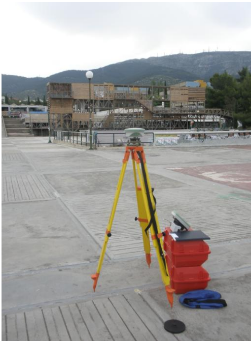
Εικόνα 3.17: Μέθοδος στατικού εντοπισμού στη στάση Σ1
