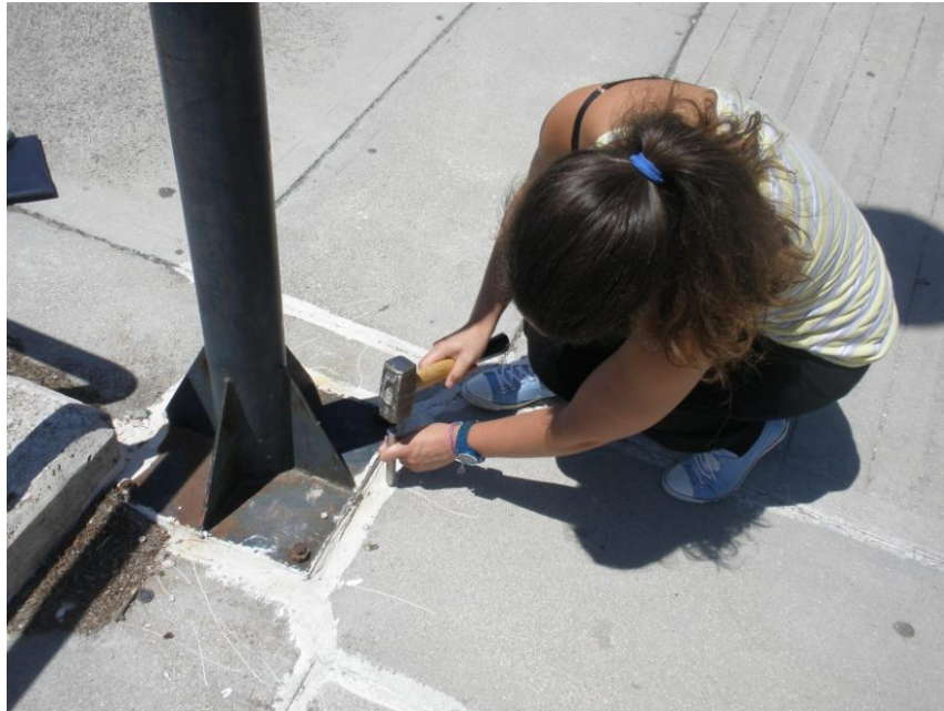
Εικόνα 3.2: Τοποθέτηση καρφιού σε προς σύγκριση σημείο
