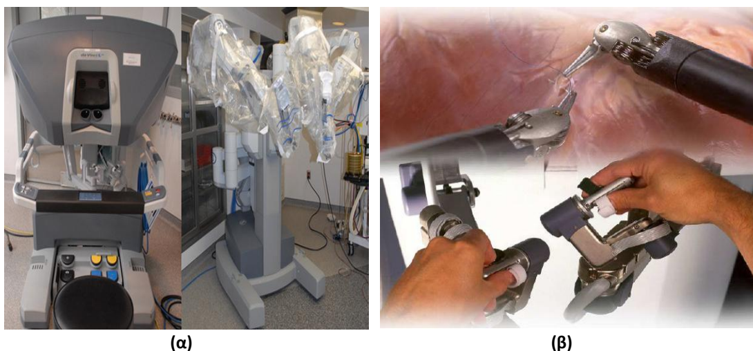
Σχήμα 2.4 (α) Η κονσόλα χειρισμού και το σύστημα των ρομποτικών βραχιόνων του Da Vinci [20], (β) Τα χειριστήρια του Da Vinci και η τεχνική προβολής της εικόνας του χειρουργικού πεδίου με τέτοιο τρόπο, ώστε να δίνεται στο χειρουργό η ψευδαίσθηση ότι χειρουργεί άμεσα τον ασθενή [17]
