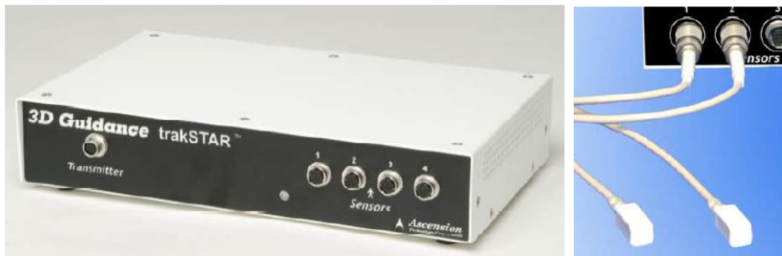
Σχήμα 4.2 Το σύστημα μαγνητικών αισθητήρων 3D Guidance trakSTAR™ της εταιρίας Ascension . Δεξιά απεικονίζεται η μονάδα ελέγχου και αριστερά οι μαγνητικοί αισθητήρες
