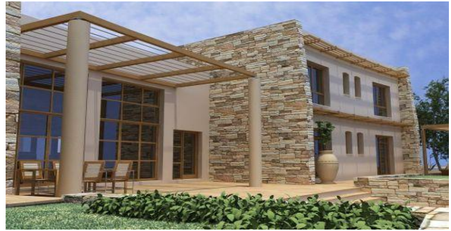
Εικ.4.6.3. Τύπος εξωτερικού σταθερού σκιάστρου-πέργκολα [121]
