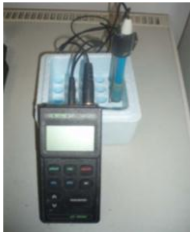
Εικόνα 31 : Φορητό pHμετρο τύπου 315i της WTW
