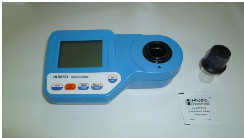
Εικόνα 28 : Συσκευή για την μέτρηση του υπολειμματικού χλωρίου τύπου HI Free chlorine ISM (όργανα HANNA)
