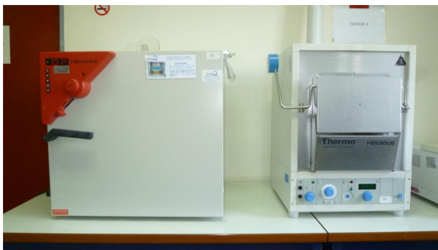
Εικόνα 29 : Φούρνοι για τον προσδιορισμό ολικών (αριστερά) και οργανικών (δεξιά) στερεών
