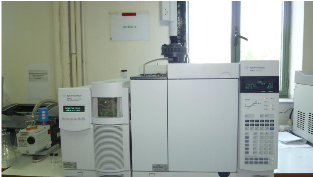
Εικόνα 32 : Αέριος χρωματογράφος τύπου Agilent 7890A συζευγμένος με φασματογράφο μάζας Agilent 5975C
