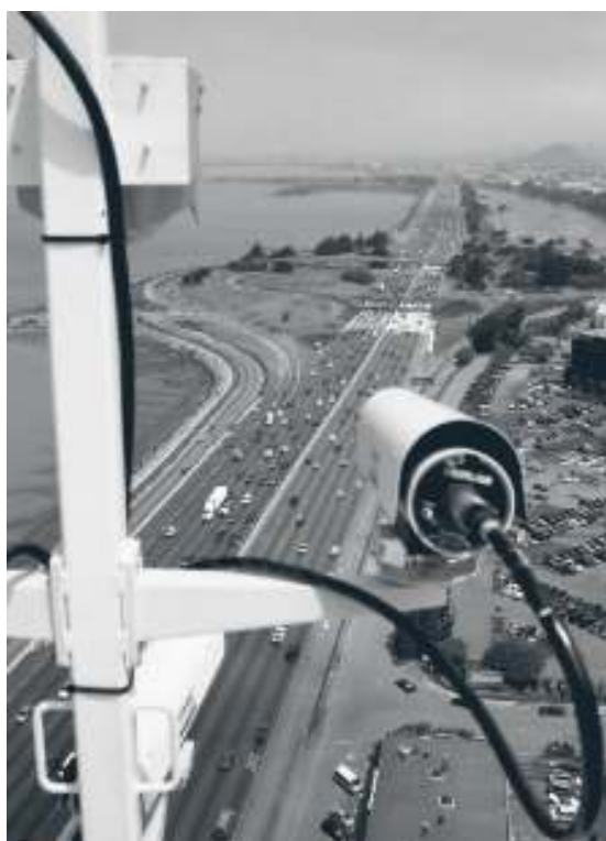
Σχήμα 5.2.: Ψηφιακή βιντεοκάμερα που καταγράφει τις τροχιές των οχημάτων στον αυτοκινητόδρομο I-80 του Σαν Φρανσίσκο από την κορυφή ενός κτιρίου Πηγή: NGSIM, 2006
