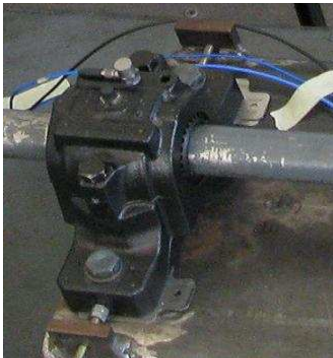
Σχήμα 7.4 Τοποθέτηση του μονό-αξονικού επιταχυνσιόμετρου PCB 352C33 πάνω από την πηγή βλάβης στην κατακόρυφη διεύθυνση, στη μεγάλη πειραματική διάταξη
