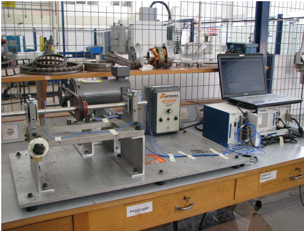
Σχήμα 7.16 Η πειραματική διάταξη Small Test Rig, με τοποθετημένα όλα τα επιταχυνσιόμετρα, το φορτίο, σε σύνδεση με το PXI, και τον υπολογιστή, έτοιμη για καταγραφή των σημάτων για τη δεδομένη τοποθέτηση των αισθητήριων οργάνων.
