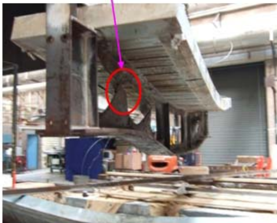
Εικόνα 2.12: Διατμητική αστοχία δοκού με πολυγωνικές οπές
