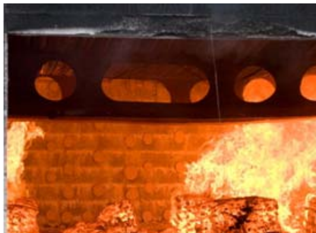
Εικόνα 2.13: Πείραμα για την αντοχή δοκών με οπές υπό συνθήκες πυρκαγιάς στο πανεπιστήμιο του Ulster
