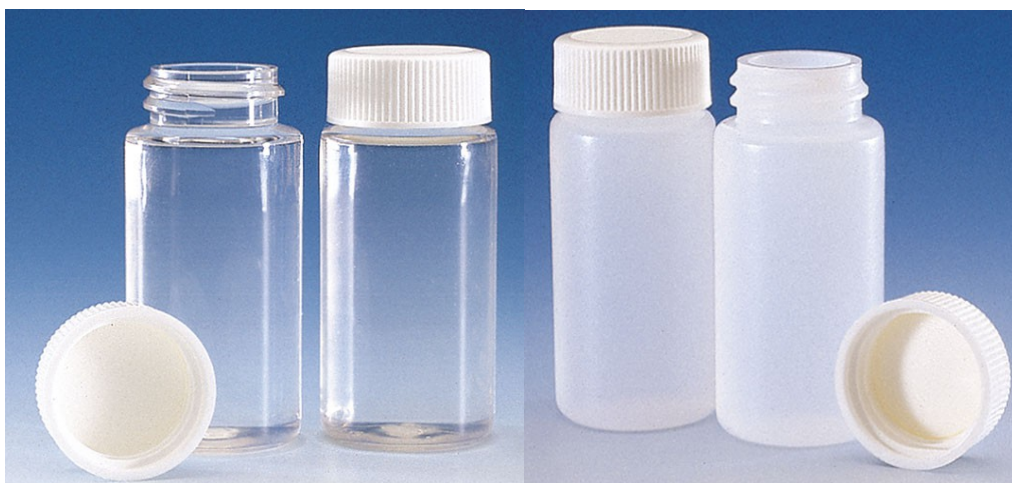
Διάγραμμα 3.4 Γυάλινα (αριστερά) και πλαστικά (δεξιά) φιαλίδια υγρού σπινθηρισμού γεωμετρίας "20 mL".
