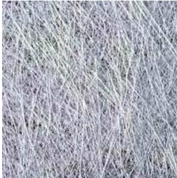
Εικόνα 7.5α Μεγέθυνση της ύφανσης του πέπλου που περιβάλλει τα άκρα των σωλήνων FRP
