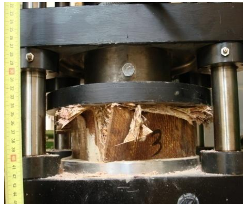
Εικόνα 7.15 Αντιστοιχία οπτικής παραμόρφωσης του δοκιμίου S03-μετατόπιση του εμβόλου της πρέσας .(συνέχεια)
