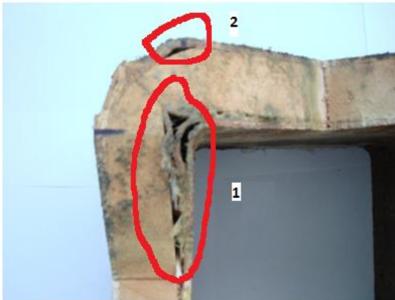
Εικόνα 7.8α Ενδεικτική παρουσίαση σφαλμάτων στην κάτοψη του S01
