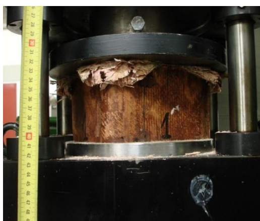
Εικόνα 7.9 Αντιστοιχία οπτικής παραμόρφωσης του δοκιμίου-μετατόπιση του εμβόλου της πρέσας.(συνέχεια)
