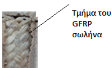
Εικόνα 7.4 Λεπτομέρεια του FRP σωλήνα όπως προκύπτει από την κάτοψη του δοκιμίου S02 (Σχεδιαστικό σφάλμα)
