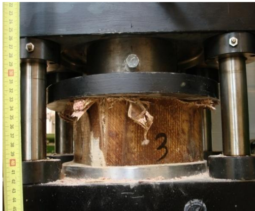
Εικόνα 7.15 Αντιστοιχία οπτικής παραμόρφωσης του δοκιμίου S03-μετατόπιση του εμβόλου της πρέσας .(συνέχεια)
