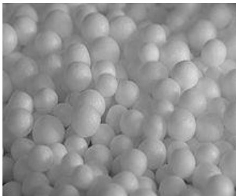
Εικόνα 4.1 Σφαιρίδια διογκωμένης πολυστερίνης διαμέτρου περίπου 2 χιλιοστών.
