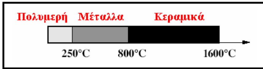
Εικόνα 2.5 Θερμοκρασιακά όρια χρήσης των υλικών
