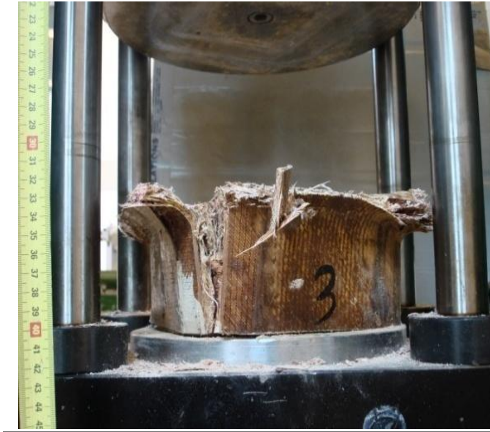
Εικόνα 7.15 Τελική απεικόνιση του δοκιμίου S03 μετά από τη πειραματική διαδικασία
