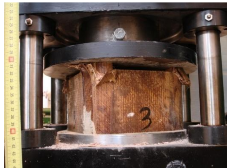
Εικόνα 7.15 Αντιστοιχία οπτικής παραμόρφωσης του δοκιμίου S03-μετατόπιση του εμβόλου της πρέσας.(συνέχεια)
