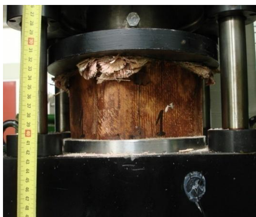
Εικόνα 7.9 Αντιστοιχία οπτικής παραμόρφωσης του δοκιμίου-μετατόπιση του εμβόλου της πρέσας.(συνέχεια)
