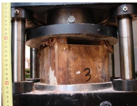
Εικόνα 7.15 Αντιστοιχία οπτικής παραμόρφωσης του δοκιμίου S03-μετατόπιση του εμβόλου της πρέσας.(συνέχεια)
