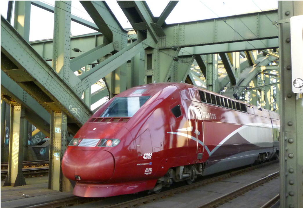
Thalys : Το ολλανδικό τρένο υψηλών ταχυτήτων βασισμένο στην γαλλική τεχνολογία τρένων TGV αναπτύσσει ταχύτητες μέχρι 320 χλμ/ώρα
