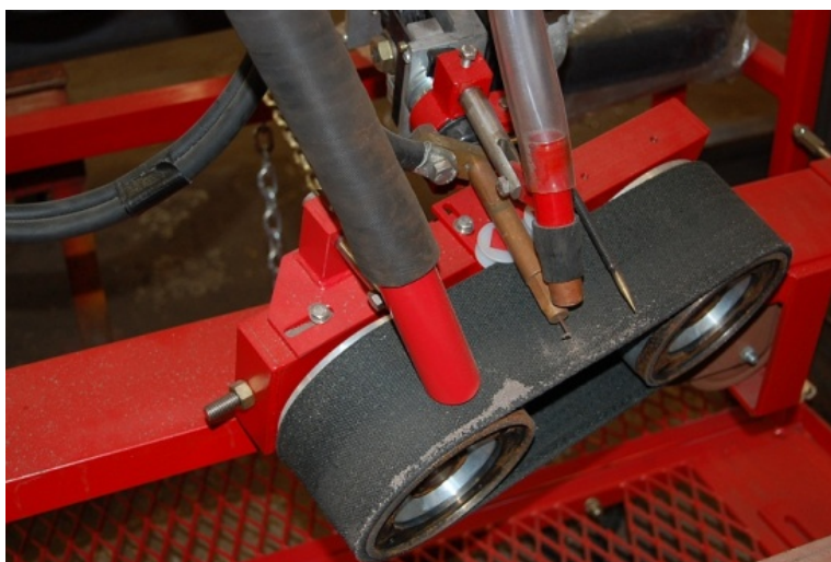
Σχήμα 6: Μηχανισμός συγκόλλησης βυθισμένου τόξου "3-o'clock welding" [14]
