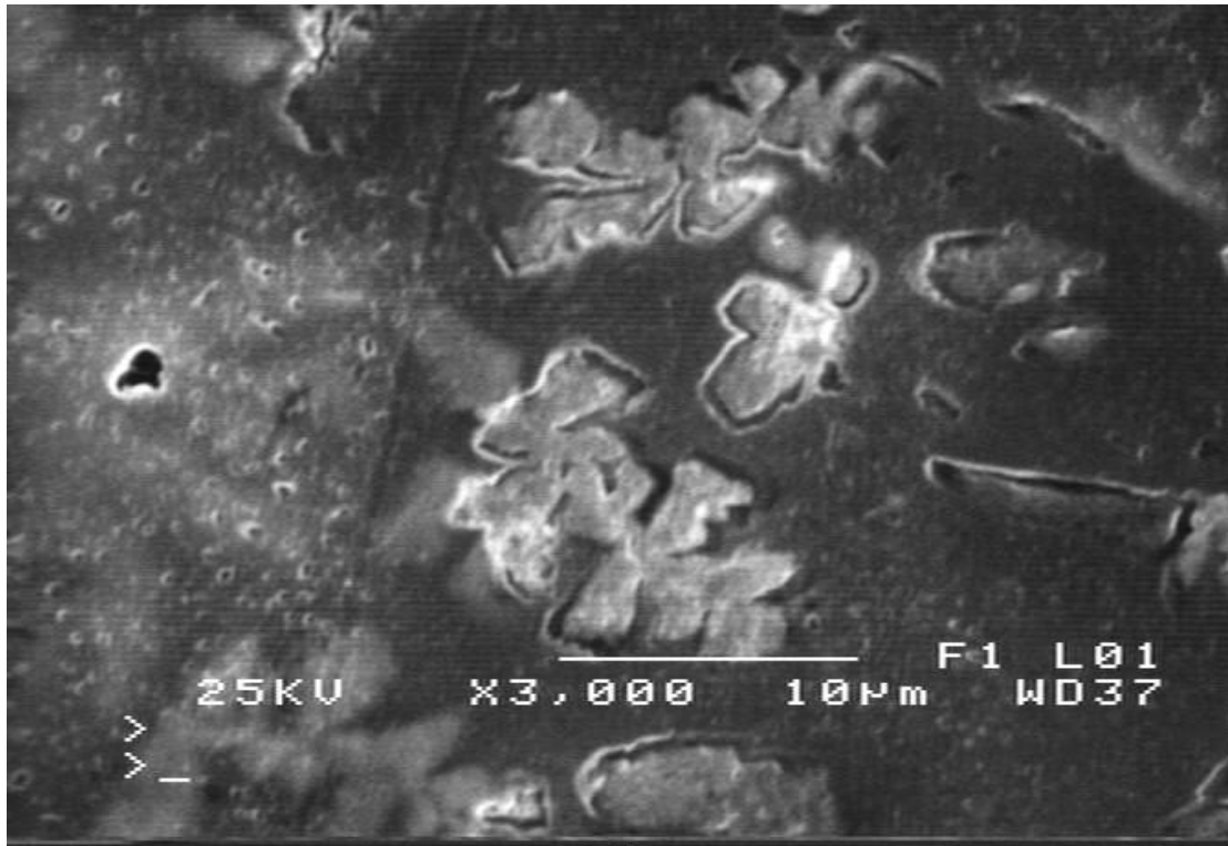
Εικόνα 5.1.2.6.: Φυλλοειδής ανάπτυξη ομάδας φάσεων από στερεοποίηση Al_{65}Cu_{20}Fe_{15} που χαρακτηρίζεται από περιορισμένο κλάσμα όγκου και εμφανίζεται σε ενδοκρυσταλλικές θέσεις φύτρωσης.
