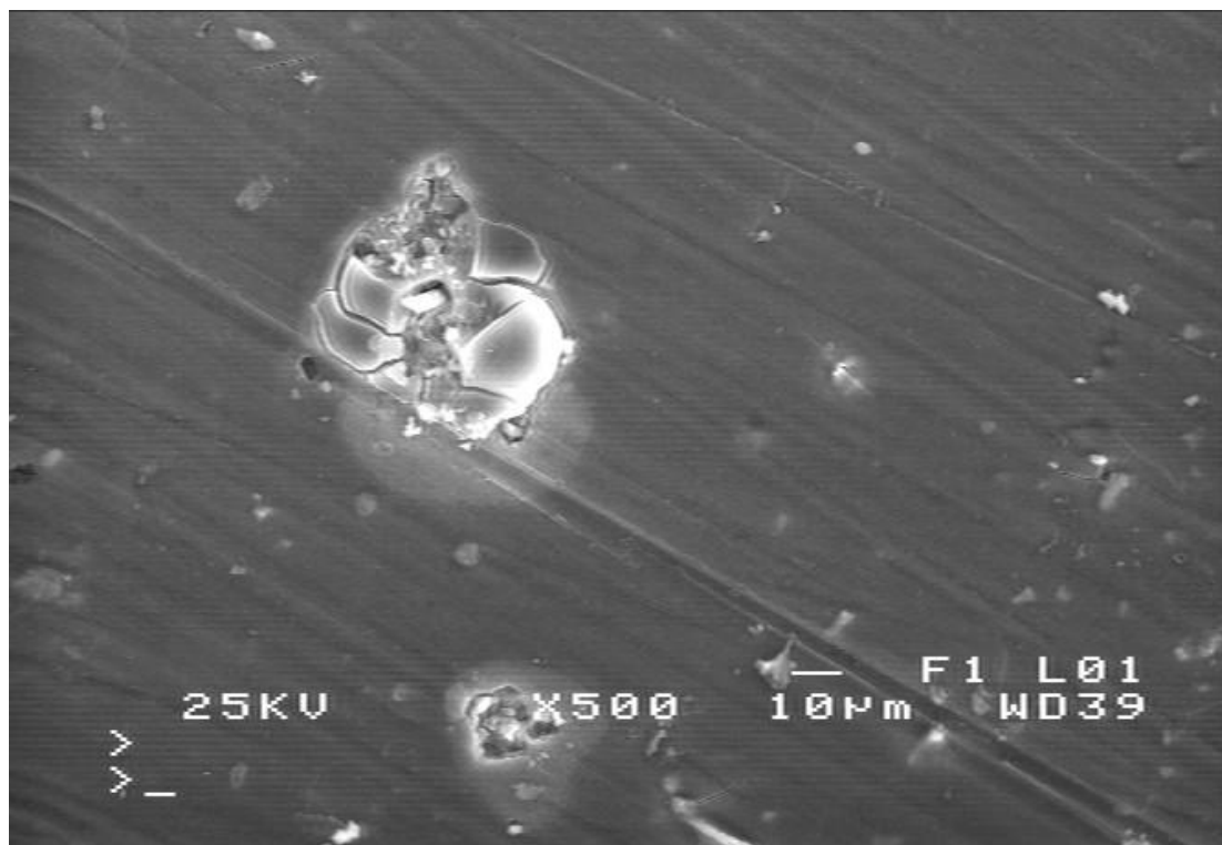
Εικόνα 5.1.7.1.: Παρατήρηση διαρρωγματομένης περιοχής στρώματος αλούμινας λόγω διάχυσης κατιόντων ( H^+ , Na^+ ) στο καθοδικό τμήμα.
