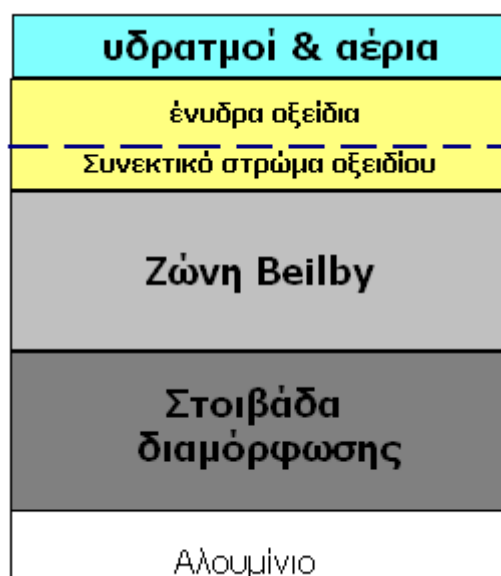
Εικόνα 2.4.1.: Προστατευτικό στρώμα οξειδίων του αλουμινίου.
