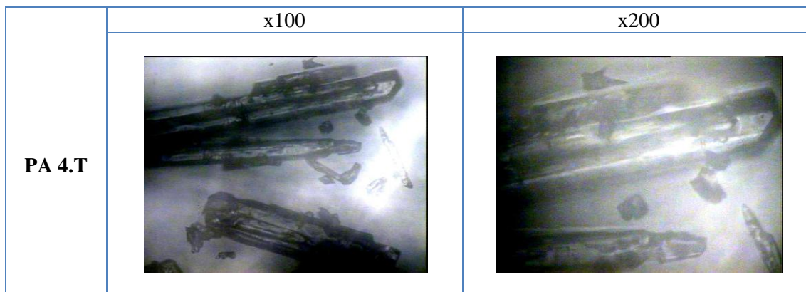
Πίνακας 5. 13 - Εικόνες από οπτικό μικροσκόπιο για δείγματα αλάτων PA 4.T της μεθόδου (2).
