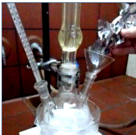
Εικόνα 4. 4 - Λιάτση για τη σύνθεση άλατος με προσθήκη στερεού δικαρβοξυλικού οξέος σε διάλυμα αμίνης.
