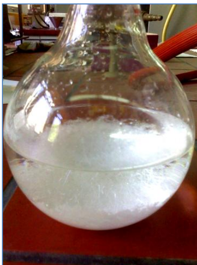
Εικόνα 4. 2 - Άλας με μεγάλο μέγεθος κρυστάλλων που λαμβάνεται με προσθήκη του νερού από τη διήθηση σε ισοπροπανόλη.
