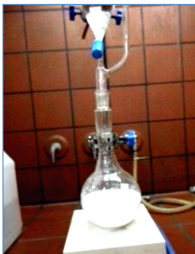
Εικόνα 4.3 - Καταβύθιση άλατος με τη προσθήκη του υδατικού του διαλύματος σε ισοπροπανόλη (1:4).
