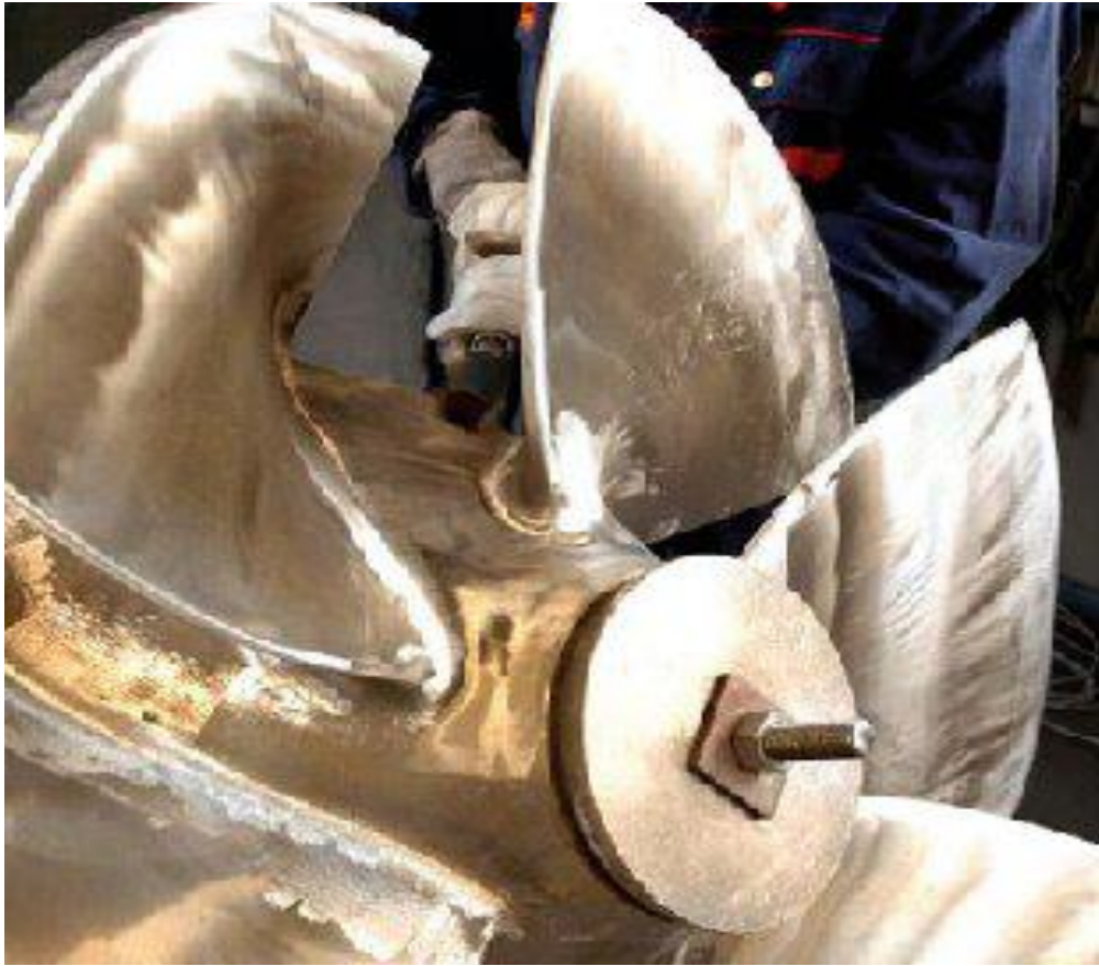
Εικόνα 2.2.5: Έλικα ωστενιτικού ανοξείδωτου χάλυβα πλοίων για πλεύση στους πάγους
