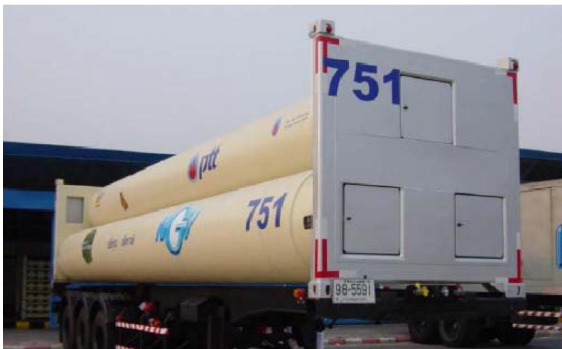
Σχήμα 3.21 : Σωλήνες υψηλής πίεσης για την αποθήκευση του αέρα
