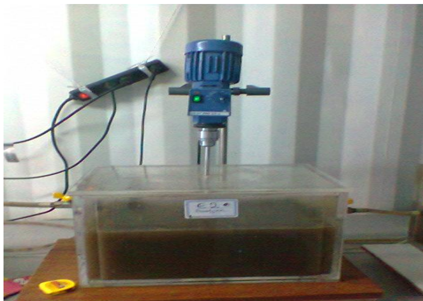
Εικόνα 4.6 Ανοξική Δεξαμενή E2
