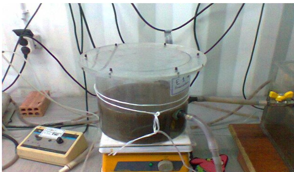
Εικόνα 4.5 Αναερόβιος Επιλογέας Ε1
