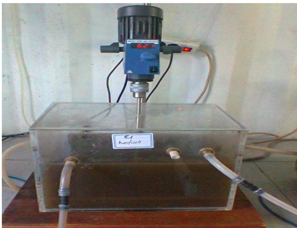
Εικόνα 4.2 Ανοξική Δεξαμενή C1
