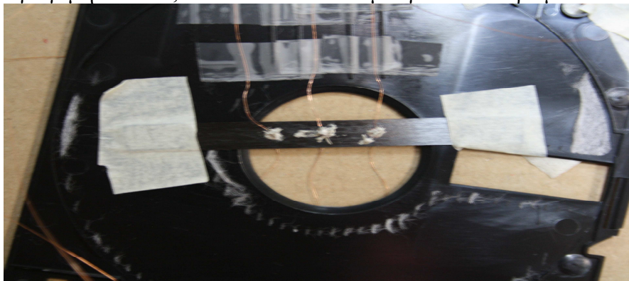
Εικ.2.2.5 Το δοκίμιο στερεωμένο στη βάση του, για ασφαλή μεταφορά. [9]
