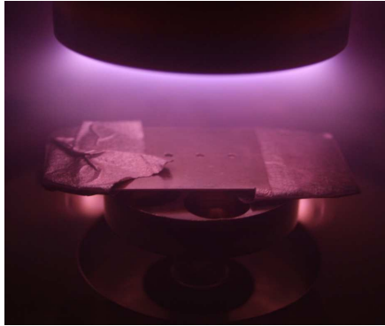
Εικ.2.2.2 Εντός του θαλάμου της EMS αφού δημιουργηθεί κενό, διοχετεύεται αργό, ως βοηθητικό αέριο στη διαδικασία εναπόθεσης. Στη συνέχεια εφαρμόζεται κατακόρυφη τάση και απ' την «πηγή» χρυσού -πάνω- αποκόλλονται σωματίδια χρυσού τα οποία καταλήγουν στο κάτω μέρος. Ενδιάμεσα παρεμβάλεται το δοκίμιο με τη μάσκα πάνω στο οποίο στρώνεται ο χρυσός.[9]
