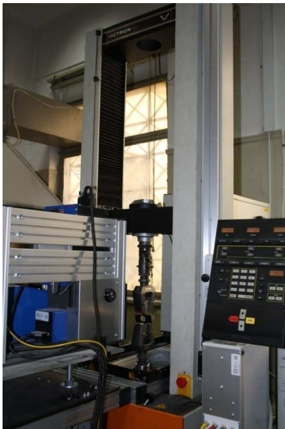
Εικ.2.3.1 και 2.3.2 Αριστερά, η Instron και το K-100 στην κοινή τους βάση. Δεξιά, το δοκίμιο πιασμένο στις αρπάγες του εφελκυστή. [9]
