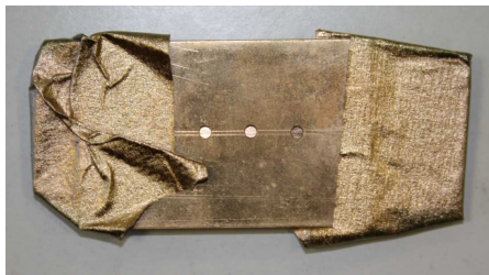
Εικ.2.2.3 Το δοκίμιο καλυμμένο με μάσκα.[9]
