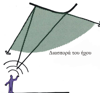
Σχήμα 2.9. Κυρτός ανακλαστήρας. (Egan M. D. 1972)
