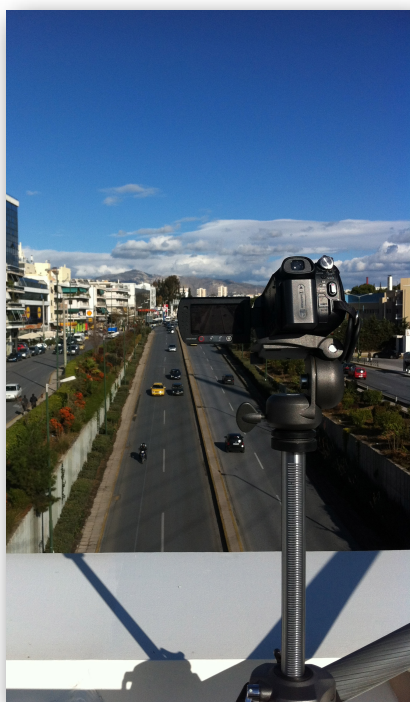
Εικόνα 14: Φωτογραφίες που ελήφθησαν την ημέρα των μετρήσεων με τον εξοπλισμό που χρησιμοποιήθηκε να έχει στηθεί και να καταγράφει την κυκλοφορία στη Λεωφόρο Μεσογείων στο ρεύμα προς Αθήνα.
