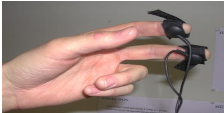
Εικόνα 3.3: Τοποθέτηση των ηλεκτροδίων για την εγγραφή του σήματος SC
