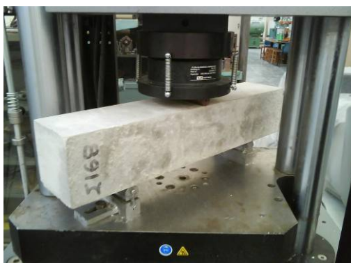
Εικόνα 29: Δοκιμή Κάμψης τριών σημείων
