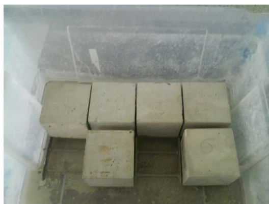
Εικόνα 33: Διεξαγωγή πειράματος Τριχοειδούς Απορρόφησης
