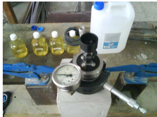
Εικόνα 36: Διεξαγωγή πειράματος Υδατοπερατότητας
