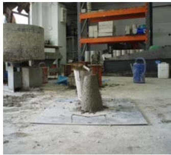
Εικόνα 22: Μέτρηση κάθισης σε συμβατικό σκυρόδεμα
