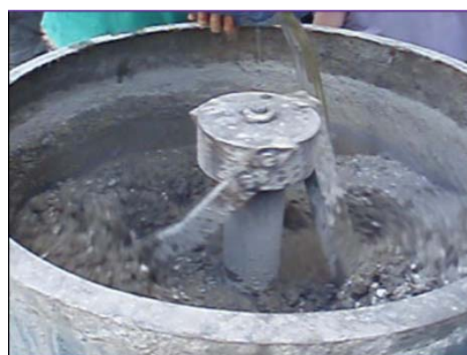
Εικόνα 16: Προσθήκη νερού και υπερρευστοποιητή και ανάμιξη
