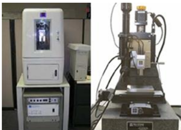
Εικόνα 28. Διάταξη νανοεγχάραξης Hysitron (Τομέας III, Σχολή Χημικών Μηχανικών, ΕΜΠ). Βασικά χαρακτηριστικά του είναι η υψηλή διακριτική του ικανότητα στη μετατόπιση της ακίδας του εγχαράκτη ( <0.5\text{nm} ), ενώ το μέγιστο βάθος διείσδυσης είναι 5\mu\text{m} , και στο εφαρμοζόμενο φορτίο ( 1\text{nN} ) με μέγιστη τιμή φορτίου 10\text{mN} .
