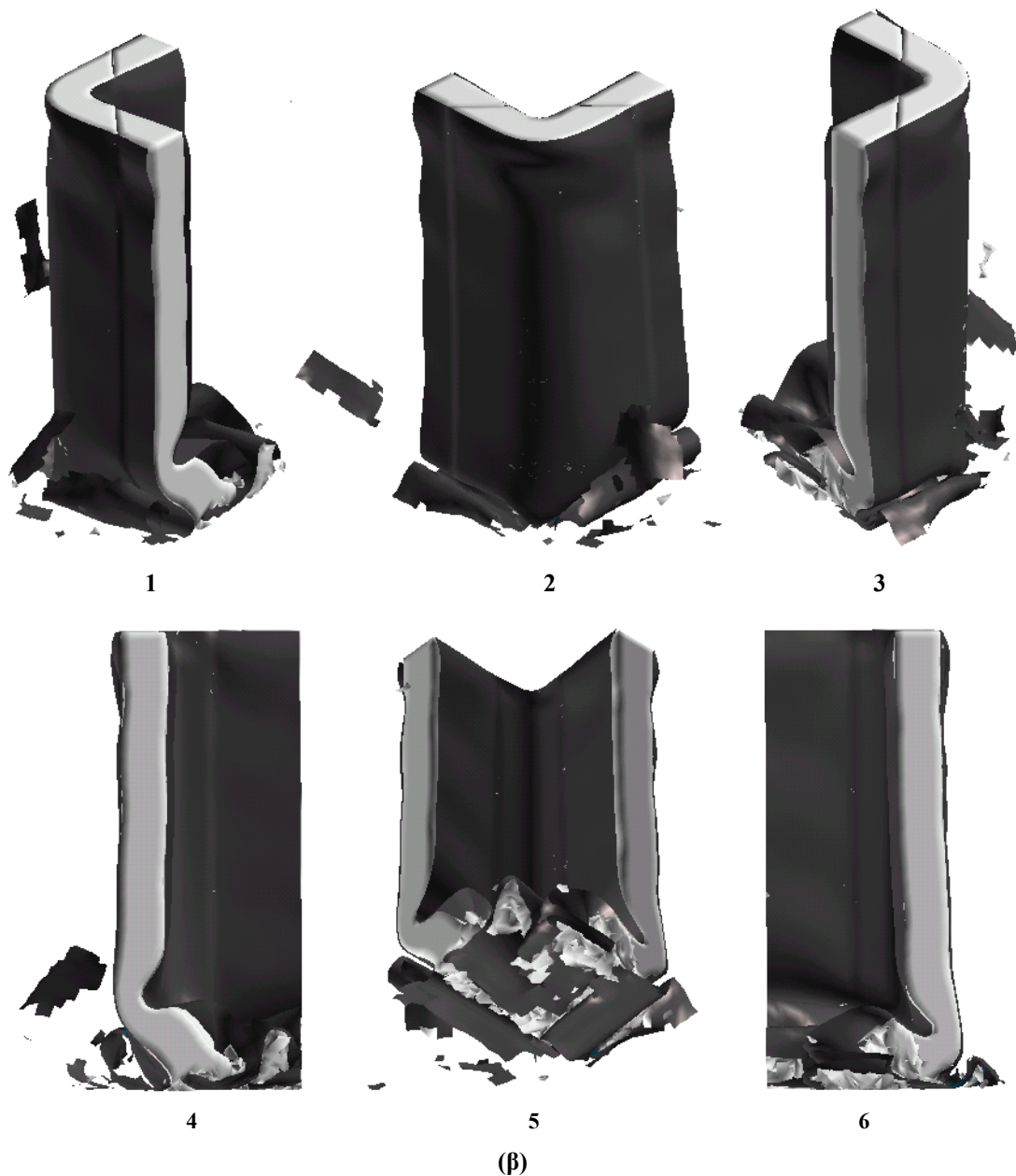
Εικ. 5.16 Τελική μορφή του “corrugated” sandwich κελύφους: α) πειραματική διαδικασία, όπου a-d: πλάγιες όψεις, e: άνοψη, f-g: τομές x-x και y-y, αντίστοιχα (βλ., α), β) προσομοίωση, όπου 1-3: εξωτερικές όψεις (περιστροφική διάταξη), 4-5: εσωτερικές όψεις (περιστροφική διάταξη)
