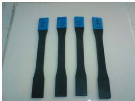
Εικόνα 4.1. α) Το καλούπι κλειστού τύπου που χρησιμοποιήθηκε για την κατασκευή των δοκιμίων β) δοκίμια από σύνθετο υλικό σιδήρου εποξικής ρητίνης.
