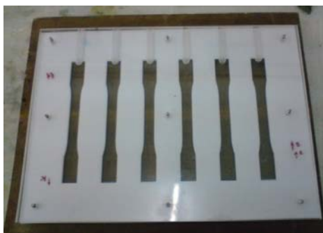
Εικόνα 4.1. α) Το καλούπι κλειστού τύπου που χρησιμοποιήθηκε για την κατασκευή των δοκιμίων β) δοκίμια από σύνθετο υλικό σιδήρου εποξικής ρητίνης.
