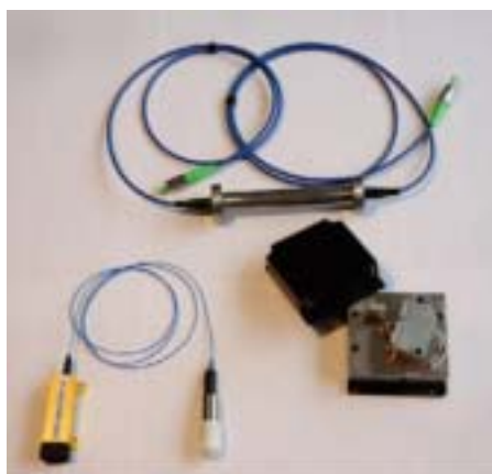
Εικόνα 1.27. Αισθητήρες οπτικών ινών FBG (Fibres Bragg Grating), οι οποίοι χρησιμοποιούνται για την παρακολούθηση της δομικής ακεραιότητας κατασκευών.
