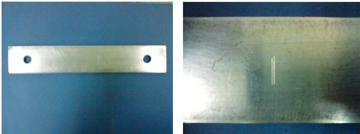
Εικόνα 7.13. Πλάκα χάλυβα πάχους 5 mm η οποία φέρει μια προκατασκευασμένη επιφανειακή ατέλεια
