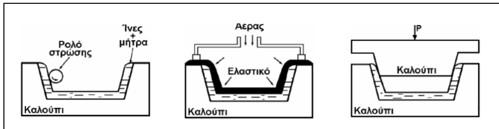
Εικόνα 2.3. Ασυνεχής μορφοποίηση συνθέτου: (α) χειροποίητη στρώση, (β) χύτευση θαλάμου πίεσης, (γ) χύτευση σε διαιρετό καλούπι.
