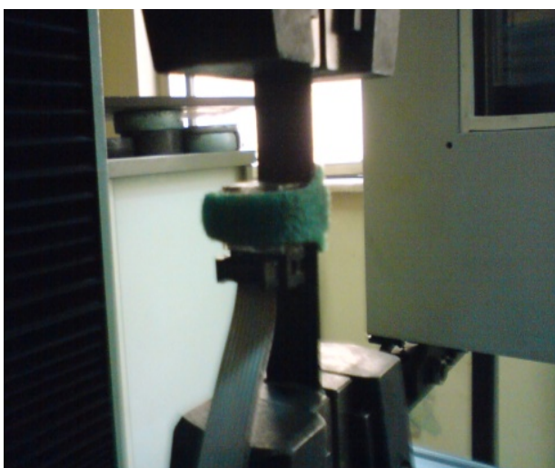
Εικόνα 5.15. Πειράματα εφελκυσμού και ταυτόχρονη καταγραφή του σήματος του επαγωγικού αισθητήρα.
