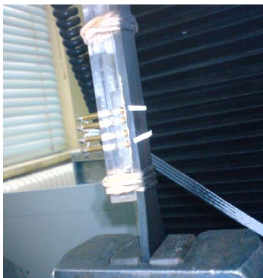
Εικόνα 6.8. Η πειραματική διάταξη που χρησιμοποιήθηκε για την μέτρηση της μεταβολής της ηλεκτρικής αγωγιμότητας \sigma , αγωγιμης βαφής, σε σχέση με την παραμόρφωση.
